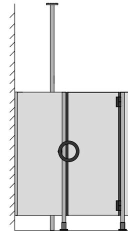
Das Stabilisierungsrohr kann direkt durch Verlängerung eines Frontprofils gebildet werden.
