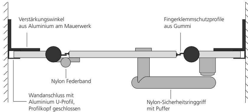
Stabilisierungslösung bei breiten Fronten
