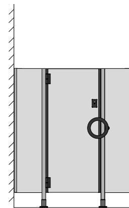
Bei Bedarf kann eine Verriegelung der Türen eingebaut werden. Diese ist so angeordnet, dass Erzieherinnen und Erzieher über die Tür greifen können, um diese im Notfall zu entriegeln.
