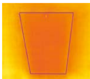
Bodentreppe mit luftdichtem Einbau: Warme Luft bleibt im Wohnraum
