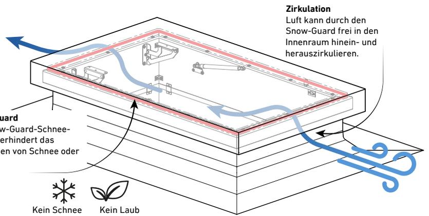
**Integrierte Belüftung:** kein Kondenswasser und Schimmel
