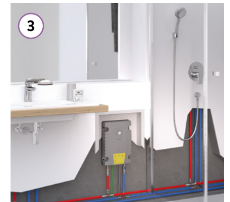
Installation in der Vorwand im Bad
