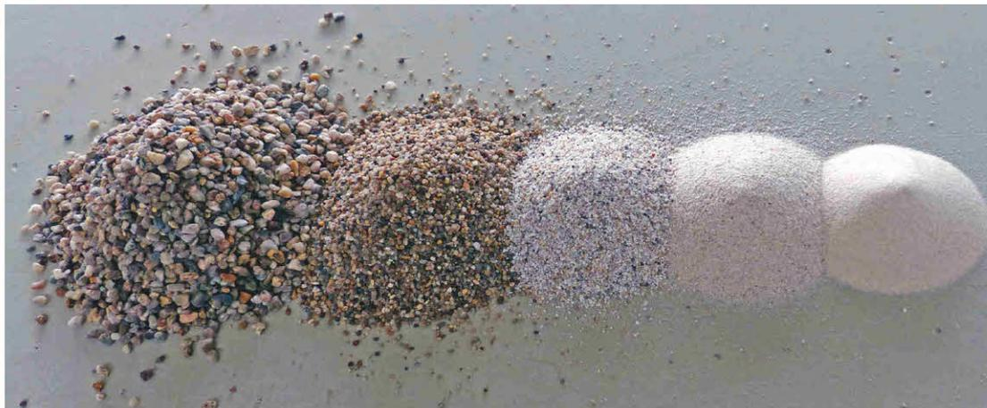
*Mineralit ist ein Hochleistungsverbundwerkstoff, der zu 94 % aus natürlichen Quarzsanden besteht (s. Bild), die mit einem hochwertigen, selbstvernetzenden Acrylharz gebunden werden. Aus diesem Material werden unsere hochverschleißfesten Formelemente gegossen.*
