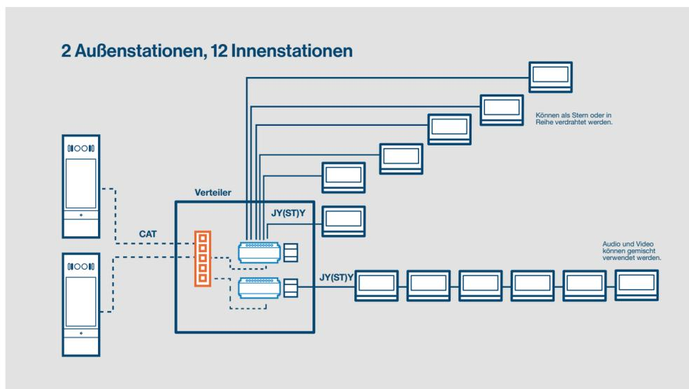
Die digitale Außenstation intercom motion ist nahezu unbegrenzt in ihren Anwendungen. Die CAT 6-Verdrahtung von außen mündet in einen Switch oder Konverter. Die weiteren Geräte können Sie über 2Draht als Stern oder in Reihe verdrahten und dabei Audio und Video mischen.
