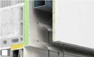
Rückseitige Dämmung MODULO.P mit entsprechender Abkantung in 20 mm oder 40 mm möglich (auch bei sichtbarem .P-System möglich). Entsprechende Führungsschienen beachten.
