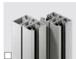
zipSCREEN.2 freistehende Führungsschiene 68 x 53 mm. Empfohlen als freistehende Führungsschiene, z. B. vor einer Schiebetür, wenn keine Schienenbefestigung Richtung Fenster-Blendrahmen möglich ist. Auch als Doppel-Führungsschiene 68 x 53 mm für Blendrahmenmontage erhältlich.
