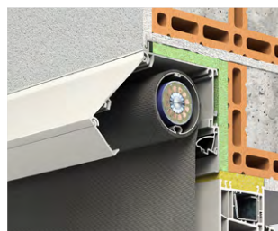
Revisionsmöglichkeit vorne am Beispiel Kasten QUADRO (sichtbar)
