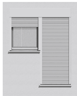
Beispielkombination mit zwei Einzelf-Führungsschienen bei unterschiedlicher Behanghöhe
