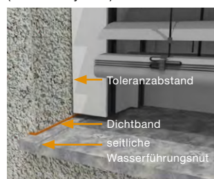
Nicht eingeputzte Führungsschiene mit Steinfensterbank
