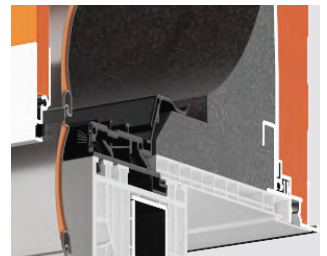
PURO 2: Anbindungsprofile zu allen gängigen Fensterprofilen verfügbar; alternativ auch Universalprofile zum Schrauben
