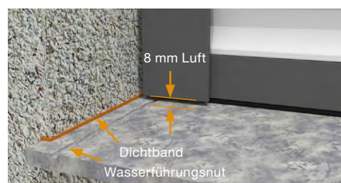
Nicht eingeputzte Führungsschiene mit Steinfensterbank
