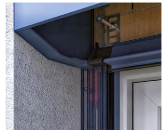
Kastenzusatzbefestigung bei Panzergewicht über 20 kg (Abb.XP-System)
