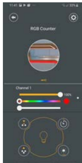
Regler für den Farblauf in %, Helligkeit und Dimmbarkeit von LED-Leisten RGB-ww (farbig & warmweiß)
