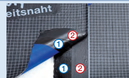
2. Die Sicherheitsnaht im Detail: ① = KSK-Randstreifen für den sofortigen Nahtverschluss durch Kaltselfstklebetechnik. ② = Schweißbarer Bereich für den sicheren Nahtverschluss mit austretendem Bitumen.
