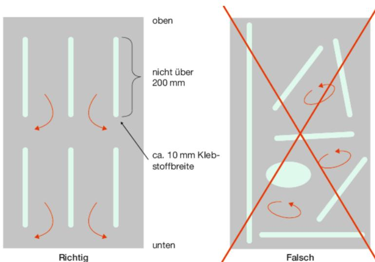
Zur Vermeidung der Einsperrung des Vernetzer-Spaltprodukts ist ein Mindestabstand zwischen Spiegel und Untergrund von 1,6 mm zwingend einzuhalten. Dieser lässt sich auf zweckmäßigste Weise durch das Aufkleben von Abstandshaltern erreichen. Der hier vorgeschriebene Mindestabstand dient dem Abtransport des Vernetzer-Spaltprodukts. Damit werden die vom Institut des Gläserhandwerks in Hadamar geforderten Mindesthinterlüftungsabstände für Spiegel in keinem Fall aufgehoben.
