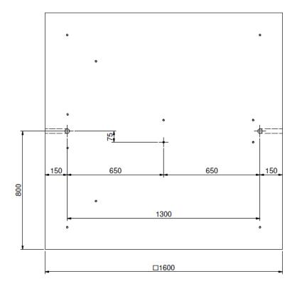
Die Fundamentplatte ist jetzt für die Montage des Drehkreuzes bereit.
