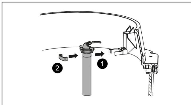
**Montaggio della sonda di allarme (solo varianti Tronic)**
