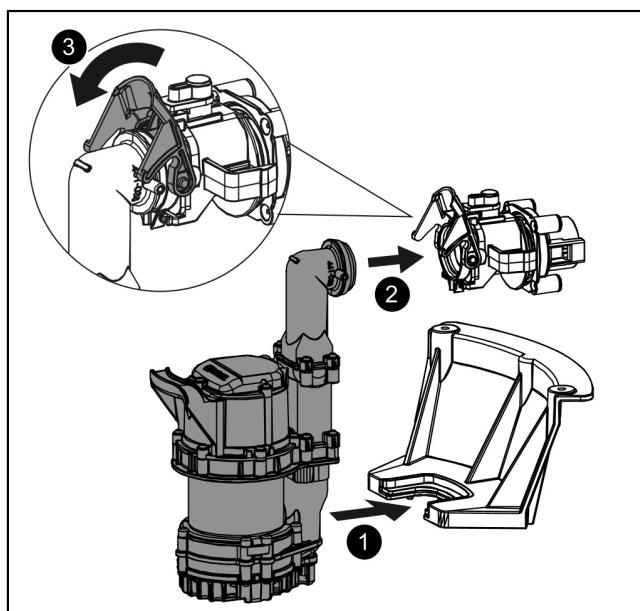
**Montage du dispositif de détection du niveau (variante Tronic uniquement)**
