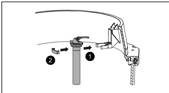
**Alarmsonde monteren (alleen Tronic-varianten)**
