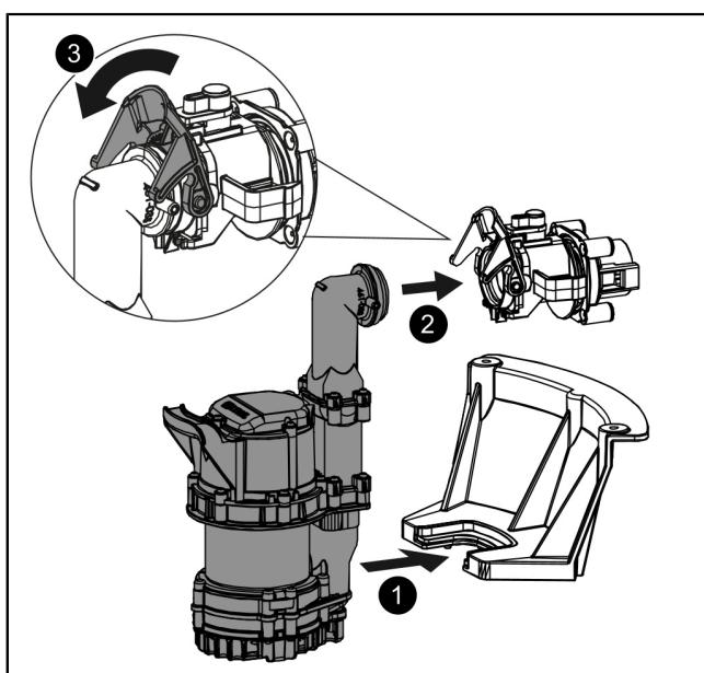
**Montaggio del rilevamento del livello (solo varianti Tronic)**
