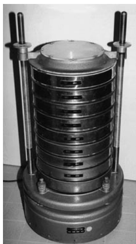
Bild 6: Siebmaschine nach DIN EN 933-1
