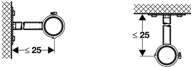
Abbildung 501: Die Fixpunkte werden bis 25 cm Decken- und Wandabstand mit der Rohrschellenbefestigung 1/2" bei DN 56 bis DN 125 und 1" bei DN 150 mit den entsprechenden Grundplatten 362.8XX.26.1 ausgeführt
