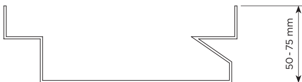
Ausführung des Rinnenkörpers bei Bauhöhen von 50 bis 75 mm
