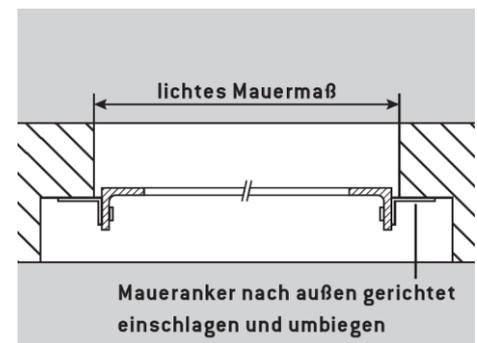
Bei Einbau ohne Anschlag: Befestigung mit vier Mauerankern
