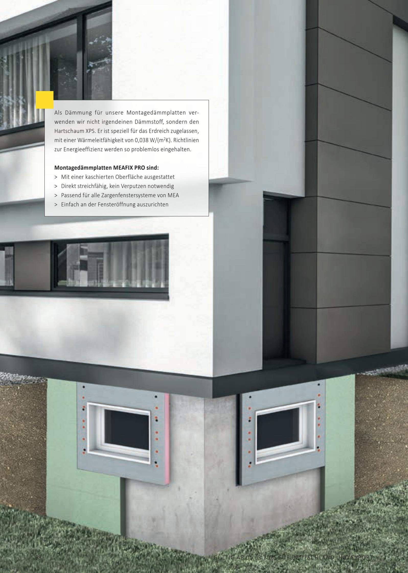
Als Dämmung für unsere Montagedämmplatten verwenden wir nicht irgendeinen Dämmstoff, sondern den Hartschaum XPS. Er ist speziell für das Erdreich zugelassen, mit einer Wärmeleitfähigkeit von  $0,038 \text{ W}/(\text{m}^2\text{K})$ . Richtlinien zur Energieeffizienz werden so problemlos eingehalten.
