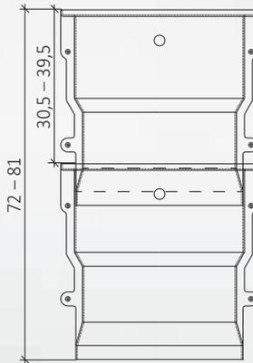
Verstellbereich bei Aufsatz mit Befestigungsösen
