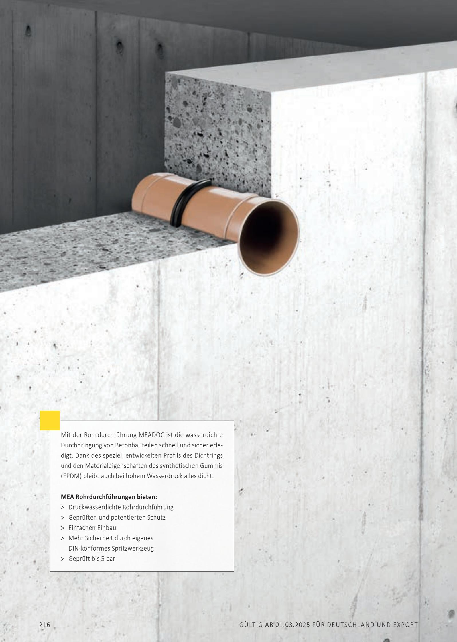
Mit der Rohrdurchführung MEADOC ist die wasserdichte Durchdringung von Betonbauteilen schnell und sicher erledigt. Dank des speziell entwickelten Profils des Dichtrings und den Materialeigenschaften des synthetischen Gummis (EPDM) bleibt auch bei hohem Wasserdruck alles dicht.
