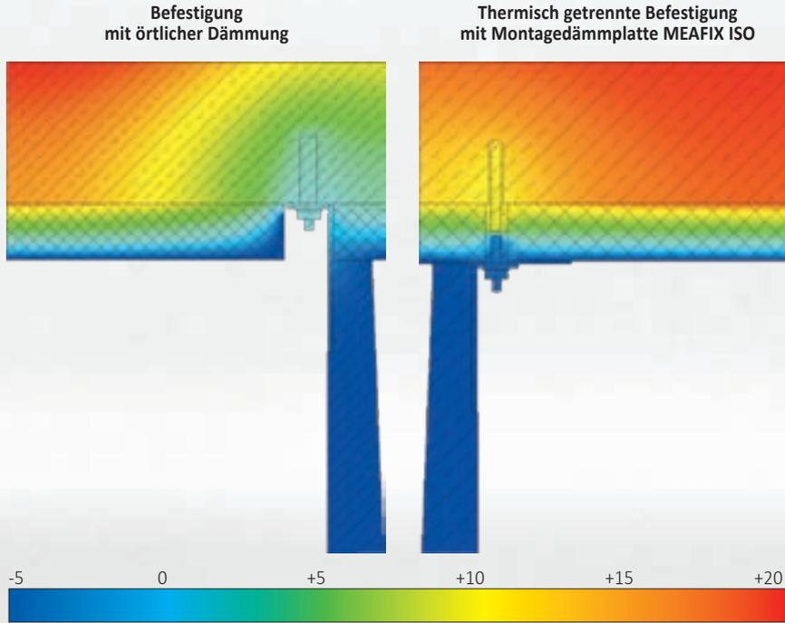
Direkter Vergleich des Temperaturverlaufs. Temperaturangaben in °C.
