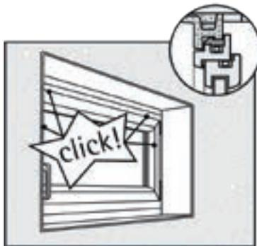
Das **MEALUXIT Zargenfenstersystem** ist dank der einmaligen CLICK-IN Funktion schnell und fehlerfrei eingebaut. Das System besteht aus einer gedämmten GFK-Wechselzarge und verschiedenen PVC Fenstereinsätzen die im Handumdrehen werkzeuglos eingebaut sind.
