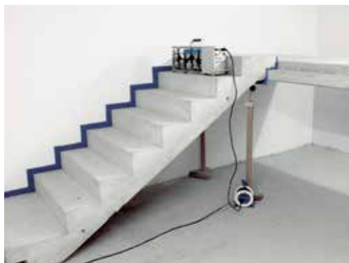
Realitätsnaher Prüfaufbau nach DIN 7396
