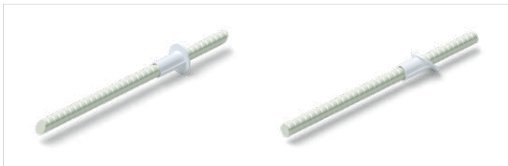
Isolink® C-SH und C-SD mit Tiefenbegrenzer zur Befestigung von Sichtbetonfassaden in Sandwichbauweise.
