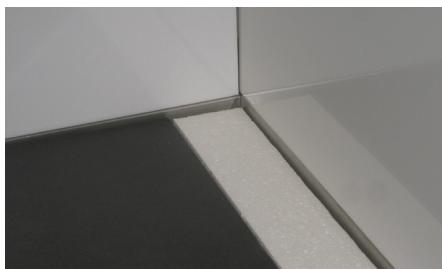
**7** Der Fliesenbelag ist nach den derzeit gültigen Normen und Regeln im Dünnbettverfahren zu erstellen. Zweite Entwässerungsebene zwischen Bodenbelag und Abdichtungsflansch im Rinnenbereich hohlräumfrei, zementär ausführen. Zur Gestaltung der Übergänge an Wand und Boden stehen unsere BLANKE AQUA PROFILE zur Verfügung.
