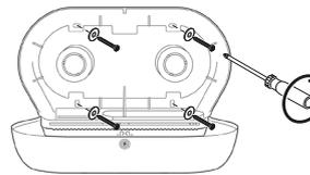
PLACE THE DISPENSER BACK ON THE WALL AND TIGHTEN THE SCREWS.
