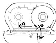
SHIFT THE WINDOW WHEN THE FIRST ROLL IS FINISHED TO PROVIDE THE SECOND ROLL.
