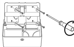
PLACE THE DISPENSER BACK ON THE WALL AND TIGHTEN THE SCREWS.
