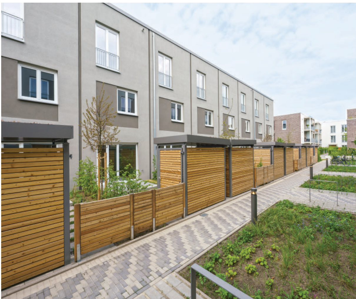
Abstellhäuser , Stützen nach RAL 9007 Graualuminium pulverbeschichtet, Seitenverkleidung Woodline 7 mm. Gründach Light.
