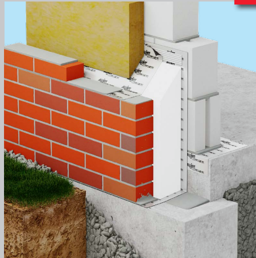
Im zweischaligen Mauerwerk auf Streifenfundament
