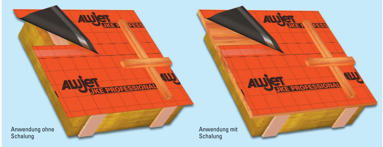
Die ALUJET JKE Professional ist eine 4-lagige, reißfeste, diffusionsoffene Unterdeckbahn aus einem Spezial-Polyolefin. Sie erfüllt die Anforderungen der DIN EN 13859-1/2 als auch die Anforderungen der neuesten ZVDH-Richtlinien. Die ALUJET JKE Professional ist geeignet für ungeschaltete und geschaltete Steildächer mit und ohne Vollsparendämmung.
