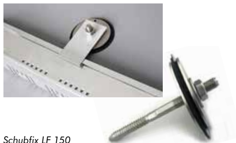
Schubfix LF 150 Der zweiteilige Schraubanker LF 150 aus Edelstahl kommt dann zum Einsatz, wenn die Belastung lediglich im Bereich von 150 kg je Haltepunkt liegt. Ideal zum Befestigen von Kiesleisten mittels Halteblech.
