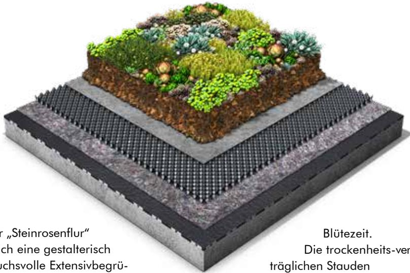
Mit der „Steinrosenflur“ lässt sich eine gestalterisch anspruchsvolle Extensivbegrünung mit individuellem Charakter realisieren. Die Substrathöhe im Systemaufbau liegt bei mind. 7 cm Systemerde „Steinrosenflur“.
