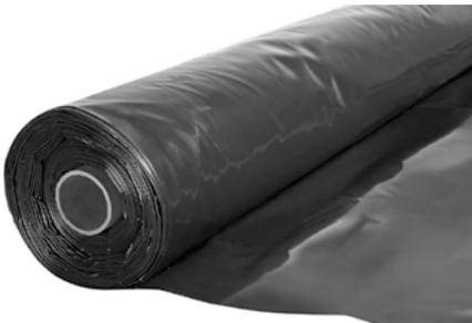
Seit Jahrzehnten bewährte, reißfeste und widerstandsfähige Hochdruck-Polyethylenfolie für den Einsatz als lose verlegter Wurzelschutz vor allem unter extensiven Dachbegrünungen und zur Auskleidung von Trögen. Wurzelfest; bitumen- und polystyrolbeständig; weichmacherfrei; huminsäure- und ölbeständig; UV-stabilisiert; WDD-äquivalente Luftschichtdicke nach DIN 52615:  $sd \geq 200$  m; Farbe: schwarz. Dicke: ca. 0,34 mm; Flächenmasse: ca. 350 g/m<sup>2</sup>.
