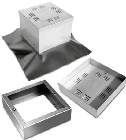
Hochwertiger Kontrollschacht aus **Edelstahl (V2A)** mit ringsumlaufender Schlitzlochung zur Aufnahme von Dränwasser; verschließbarer, trittstabiler Deckel mit Wassereinlassöffnungen und mit in der Höhe verschiebbarer Folien-Manschette zum lückenlosen Anschluss des Systemfiltervlieses. Farbe: Edelstahl natur; Gewicht: ca. 4,0 kg; Schacht-Außenmaß: ca. 300 mm × 300 mm; Öffnungsmaß: ca. 240 mm × 240 mm.
