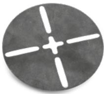
Die Distanzscheibe mit 1 mm Dicke aus Kautschuk wird auf Elering gelegt, um geringfügige Höhendifferenzen auszugleichen. Auf dem Kopfteil von Elefeet® Stelzlager kann die Distanzscheibe als Rutschsicherung dienen.
