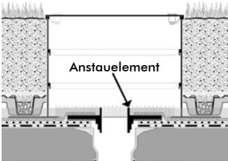
Anstaeuelement zum Aufsetzen auf Flachdachabläufe mit Anschlusskragen und Mindestgröße DN 100. Gewicht ca. 4,6 kg. Besteht aus einem Edelstahlflansch mit unterseitiger Gummidichtung, Durchmesser ca. 280 mm und einem höhenverstellbarem Überlaufstutzen (Einstellbereich von ca. 10–75 mm) aus Kunststoff, Innendurchmesser ca. 75 mm.
