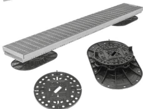
Fassadenrinnen in 40, 50 und 75 mm Höhe, Breite 150 mm. Aus Aluminium stranggepreßt, mit begehbarem Gitterrost aus feuerverzinktem Stahl; Maschenweite 33 mm × 11 mm; sichert den zügigen Abfluss des an Fassaden verstärkt anfallenden Niederschlagswassers; ermöglicht niedrige Anschlusskonstruktionen im Tür- und Terrassenbereich.
