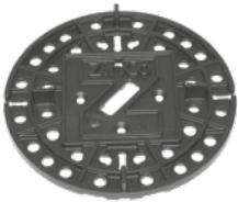
Auflageteller aus RC-Polypropylen-Kunststoff für die Plattenverlegung auf ZinCo Elefeet Auflage-Schiene; Höhe Teller ca. 6 mm, Durchmesser ca. 120 mm; mit 3 mm Fugenteiler; Pack à 50 Stück; vorgelocht zum Aufschrauben auf die Auflage-Schiene; inkl. 52 St. Schrauben SIT 20 und Bit
