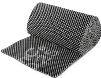
Für den Einsatz z. B. bei der Begrünung von Tonnendächern ist es vorteilhaft, anstatt Dränage-Platten Dränage-Rollbahnen zu verwenden, die durchgehend verlegt und auf Zug belastet werden können. Zu diesem Zweck bieten wir Floradrain® FD 25 als Rollenware an. Standard-Rollenlänge: 15 m; Material: aus tiefgezogenem Recycling-Polyolefin (hpts. PE).
