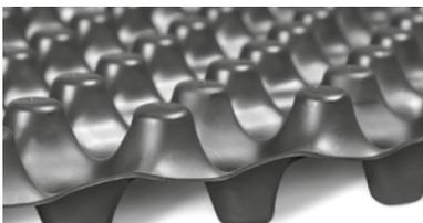
Drän- und Wasserspeicherelement aus tiefgezogenem Recycling-Polyolefin (hpts. PE); mit Wasserspeichermulden; Öffnungen zur Belüftung und Diffusion sowie unterseitigem, durchgehendem Kanalsystem. Mehr Infos auf Seite 9.
