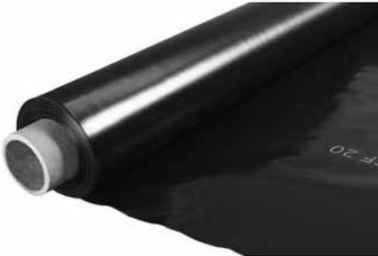
Chemisch neutrale Hochdruck-Polyethylenfolie zum Einsatz als Trenn- und Gleitfolie unter Dachbegrünungen oder Geh- und Fahrbelägen; bitumen- und polystyrolverträglich; beständig gegenüber den meisten Chemikalien; UV-stabilisiert; glatte Oberfläche; dampfsperrend ( $s_d \geq 100$  m); Farbe: schwarz; Dicke: ca. 0,20 mm; Flächenmasse: ca. 190 g/m<sup>2</sup>; WDD-äquivalente Luftschichtdicke:  $s_d \geq 40$  m; Gleitreibungskoeffizient: 0,30.
