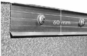
Anpressprofil gemäß Punkt 4.2.1 der Flachdachrichtlinien für Folien- und Bitumenabdichtungen; aus Aluminium-natur; stranggepresst; mit breiter Auflagefläche; vorgelocht im Abstand von ca. 200 mm. Profil-Höhe: ca. 60 mm.
