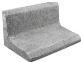
**Öko-Betonwinkelstein** zur Einfassung von Pflanzbereichen, zur Abgrenzung von Geh- und Terrassenbelägen oder zur Ausbildung von Trögen, etc. Länge ca. 500 mm; Schenkellängen: ca. 250 mm / 300 mm; beidseitig verwendbar; Gewicht: **nur ca. 28,5 kg**.
