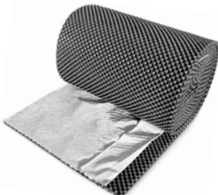
Für eine besonders rationelle Verlegung von Begrünungsaufbauten mit Floradrain® FD 25 gibt es dieses auch als Rollenware mit aufkaschiertem Systemfiltervlies. Das Systemfiltervlies hat einen einseitigen Überstand von ca. 100 mm. Das größere Transportvolumen von Rollenware gegenüber Plattenware ist jedoch zu beachten! Material: aus tiefgezogenem Recycling-Polyolefin (hpts. PE).
