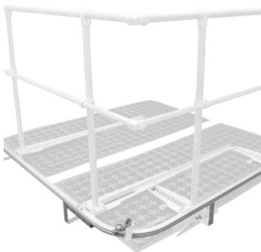
In Kombination mit der ZinCo Geländerbasis GB/GB-Eck zu montierendes Schienensystem mit horizontal beweglichem Anschlagpunkt, dem sogenannten Läufer; geprüft als durch Auflast gehaltene Anschlagvorrichtung gegen Absturz gemäß DIN EN 795:2012 Typen D und E.
