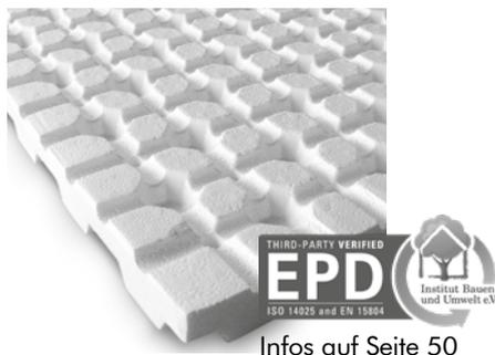
**Dränplatte zum Einsatz unter Extensivbegrünungen auf Flachdächern mit und ohne Gefälle;** aus EPS-Hartschaum; FCKW-frei; ohne HBCD; mit Wasserspeichermulden; Öffnungen zur Belüftung und Diffusion sowie unterseitigem, durchgehendem Kanalsystem; Drainageleistung geprüft nach DIN EN ISO 12958; Rohdichte: ca. 20 kg/m<sup>3</sup>; Flächenmasse: ca. 0,6 kg/m<sup>2</sup>; Höhe: ca. 50 mm.
