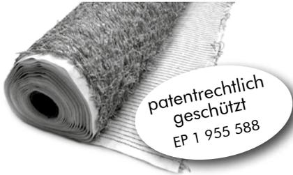
Wasserverteilendes und einseitig mit kapillar wirksamen Fasern bestücktes Vlies für den Einsatz in Verbindung mit dem Systemaufbau „Sponge-City-Roof“ zur temporären Retention. Material: Polyester; Farbe: weiß (Vlies), grau (Fasern); Flächenmasse ca. 600 g/m<sup>2</sup>; Faserlänge ca. 40 mm.
