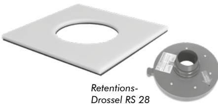
Anstau-Scheibe zur Schaffung eines Anstaus in Kombination mit der Retentions-Drossel RS 28 (siehe Seite 24); aus Polyethylen mit unterseitiger flächiger Dichtung aus Zellkautschuk, Gesamthöhe 13 mm, Abmessungen 280 × 280 mm.
