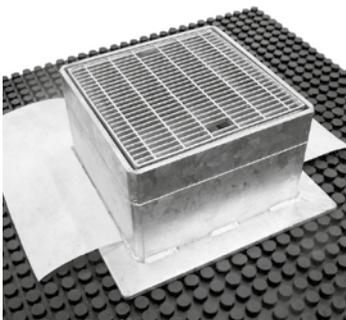
**Befahrbarer Entwässerungsschacht aus feuerverzinktem Stahl**; Schacht-Außenmaß ca. 300 mm × 300 mm; Flansch: ca. 400 mm × 400 mm; mit verschraubtem Gitterrost; Maschenweite: ca. 44 × 11 mm; Sandfang aus Aluminium und druckverteilendem Auflageflansch; Öffnungsmaß: ca. 200 mm × 200 mm.
