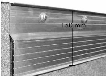
Anpress- und Schutzprofil gegen UV-Strahlung und Witterungseinflüsse; für Folien- und Bitumenabdichtungen; aus Aluminium-natur; stranggepresst; mit breiter Auflagefläche; entsprechend den Flachdachrichtlinien; vorgelocht im Abstand von ca. 200 mm; Profil-Höhe: ca. 150 mm.
