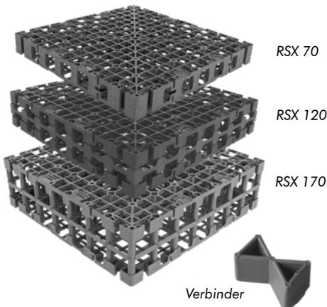
Leistungsfähiges, hochbelastbares Spacer-Element, im Spritzguss-Verfahren aus 100 % Polypropylen hergestellt, Höhe ca. 70 mm bis 170 mm; mit einem Hohlraumvolumen von mehr als 95 %; max. Einstauvolumen ca. 66 l/m<sup>2</sup>, 114 l/m<sup>2</sup> und 161 l/m<sup>2</sup>; Druckbelastung nach DIN EN ISO 17151: bis 50 t/m<sup>2</sup>; zum Einsatz bei Retentions-Gründächern auf Dachflächen ohne Gefälle; auf denen z. B. Geh- oder Fahrbeläge oder hohe Substratschüttungen realisiert werden sollen.
