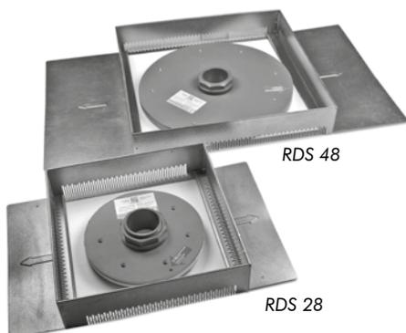
Set bestehend aus **Retentions-Drossel RD 48** + **Kontrollschacht KS 10/57** (siehe Seite 27); **Retentionsdrossel** einstellbar; zum Einbau über Flachdachabläufen mit Schraubflansch, Flansch aus Hart-PVC; Überlaufstutzen und Einstellringe aus Kunststoff; Durchmesser Flansch ca. 480 mm; Durchmesser Überlaufstutzen ca. 75 mm; Überlaufhöhe max. ca. 85 mm; Gewicht ca. 4,5 kg.
