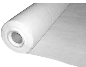
Hitzebeständiges Vlies aus verfestigtem Polyester zum Einsatz auf Elastodrain® EL 202 für den Handeinbau von Asphaltbelägen. Bitte Einbauanleitung beachten! Dicke ca. 1,0–1,4 mm, Flächenmasse ca. 200 g/m<sup>2</sup>, Farbe weiß, Höchstzugkraft min. 400 N/5cm, Reißdehnung längs/quer ca. 35/50 %, Schmelzpunkt > 200 °C.
