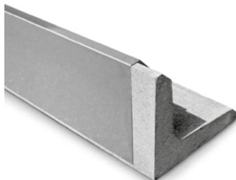
**Blende für Betonwinkelstein** aus gekantetem, foliertem Edelstahlblech; Höhe ca. 240 mm; damit bei beiden Verlegearten (250- oder 300 mm-Schenkel nach oben) einsetzbar; Profillänge ca. 2 m; mit integriertem Stoßverbinder. Vorgefertigte Innen- und Außenecken auf Anfrage; Gewicht: ca. 5,0 kg.
