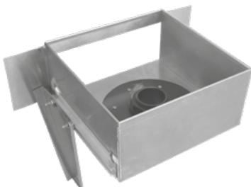
Randübergabeschacht aus Aluminium für Anschluss eines Fallrohrs am Tiefgaragenrand und Aufnahme der Retentionsdrossel RD 28, mit Anschlusskragen zum Eindichten mit Flüssigkunststoff an der bauseitigen Aufkantung; inkl. 2 Konsolen aus verzinktem Stahl; Höhe ca. 200 mm; Deckel ca. 400 × 400 mm; Gewicht ca. 9 kg.
