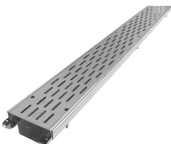
Höhenverstellbare Rinne aus hochwertigem Edelstahl; Abdeckung mit Langlochschlitzung, Rinnenkörper unten/seitlich geschlitzt, einschließlich Stoßverbinder. Rinnenbreite: ca. 107 mm, Höhenverstellbereich: ca. 40 mm bis 55 mm.
