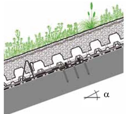
Mit der Los-Festflansch-Konstruktion Schubfix LF 300 und dem Traufprofil TRP 80 lassen sich auch Schubschwellen in der Fläche ausbilden.
