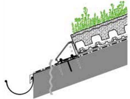
Dachtraufprofil aus Edelstahl, fixiert mit Schubfix LF 600. Bei Bedarf mit Edelstahlblende. Siehe auch Abb. Seite 6.
