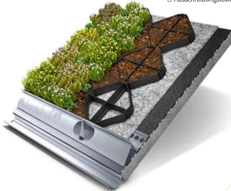
Mit dem hier vorgestellten Systemaufbau „Begrüntes Steildach“ auf Grundlage der ZinCo Georaster®-Elemente wird auch die Begrünung von Dachflächen mit über 25° Neigung möglich. Die ca. 54 × 54 cm großen und 10 cm hohen Georaster®-Elemente aus Recycling-Polyethylen (HD-PE) werden ohne Werkzeuge einfach ineinandergesteckt. Dies bewirkt sofort einen stabilen, flächigen Verbund.
