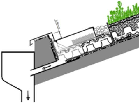
Prinzipiell ist auch eine Entwässerung mit Gullys möglich. Diese sind jedoch direkt vor der Traufaufkantung einzubauen; ein Abstand von 30 cm, wie von den Flachdachrichtlinien üblicherweise für Dachdurchdringungen etc. gefordert, ist hier nicht praxisgerecht.
