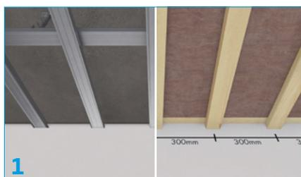
Profile mit einem Achsabstand von 300 mm montieren. Verwenden Sie Metall-Profile oder Holzlattung mit mind. 60 mm Breite.
