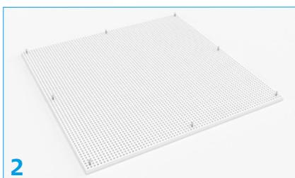
Bereiten Sie die Platten für die Montage vor, indem Sie die Cleaneo GO! Spezialschrauben in die zweite Loch-Reihe einsetzen. Pro 600 x 600er Platte 8 Schrauben, je eine in den 4 Ecken und in der Mitte jeder Seite. Für die Platte im Format 600 x 1.200 mm jeweils 13 Schrauben.
