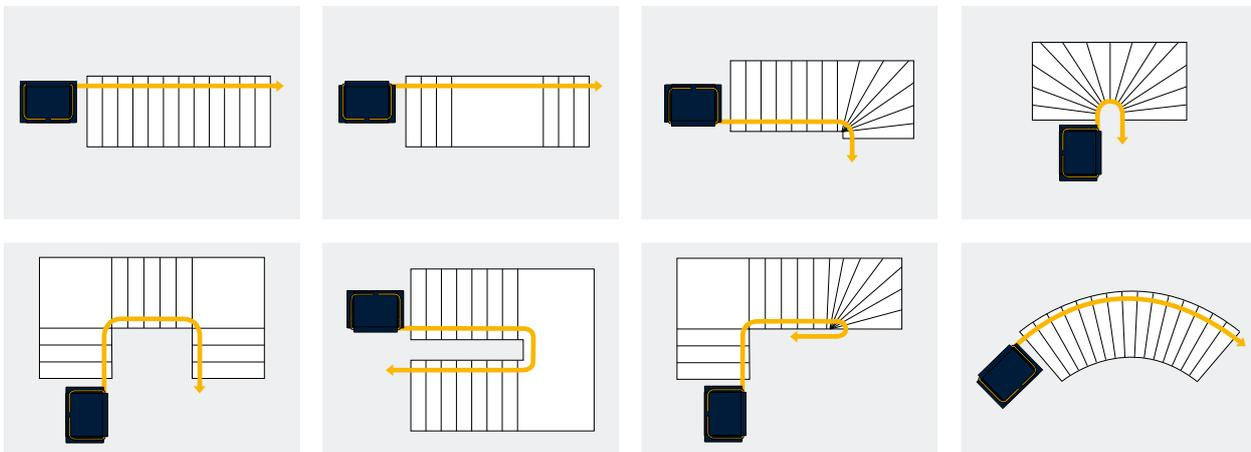
Einige Beispiele für häufig vorkommende Treppensituationen: Anders als Treppensitzlifte werden Plattform-Schrägaufzüge aufgrund ihrer größeren Abmessungen in der Regel an geraden Treppen oder an der Innenseite von kurvigen Treppen montiert. Bei weit geschwungenen Treppen kann der Aufzug auch an der Treppenaußenseite angebracht werden.
