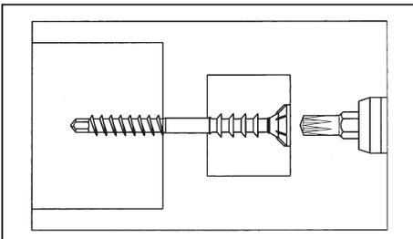
Jamo plus Schraube mit AW30 Antrieb einschrauben, bis Holzlatte an Untergrund anliegt und der Schraubenkopf mindestens 2 mm in der Holzlatte versenkt ist.
