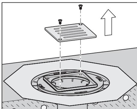
→ Cr-Ni-Rahmen und Aufsatzrahmen 3 mm vom Verschieberahmen abschrauben und abnehmen (Bild).
