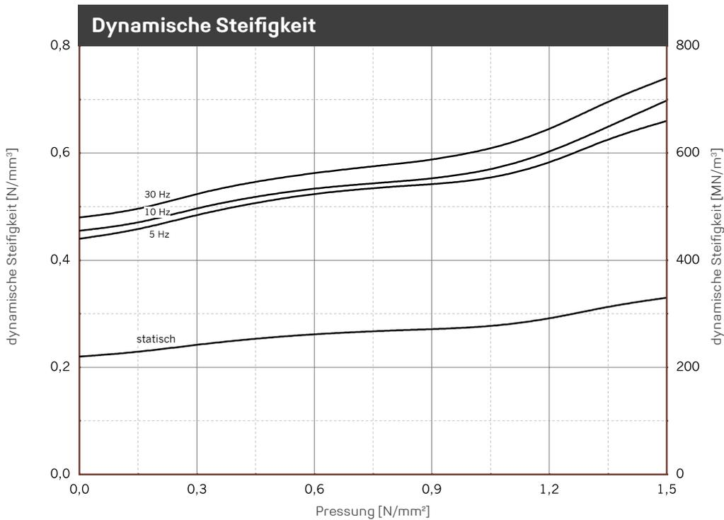
Verlauf der dynamischen Steifigkeit bei sinusförmiger Anregung um eine konstante Mittellast, Wegamplitude  $\pm 0,10$  mm. Probenabmessung 250 mm x 250 mm x 25 mm; Statische Steifigkeit als Tangentenmodul aus der Federkennlinie. Messung in Anlehnung an DIN 53513.
