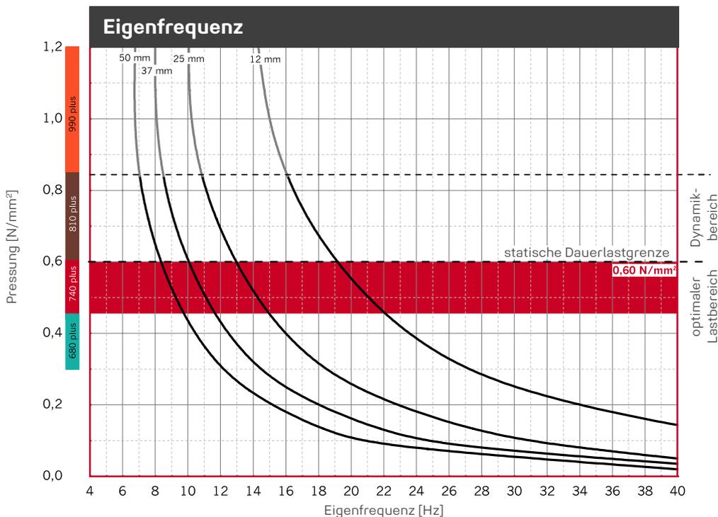
Eigenfrequenzverläufe für einen eindimensionalen Feder-Masse-Schwinger unter Berücksichtigung der dynamischen Steifigkeit von **REGUFOAM vibration 740plus** auf starrem Untergrund. Probenabmessung 250 mm x 250 mm.
