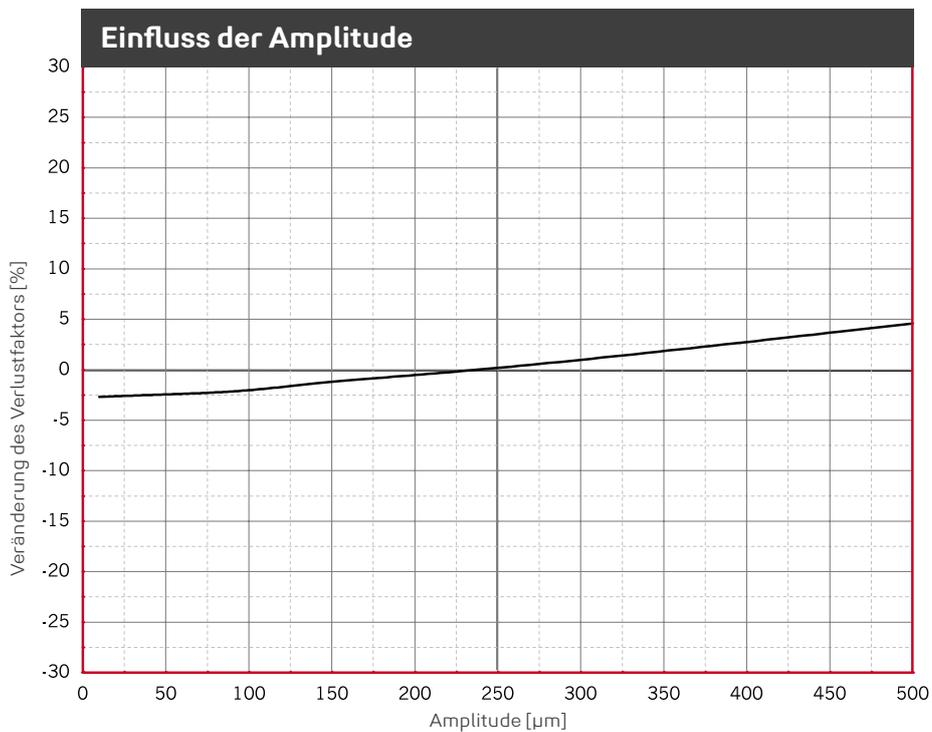
Veränderung des Verlustfaktors aufgrund geänderter Anregeamplitude. Sinusförmige Anregung bei konstanter Mittellast von 0,600 N/mm<sup>2</sup>, Probenabmessung 250 x 250 x 50 mm.
