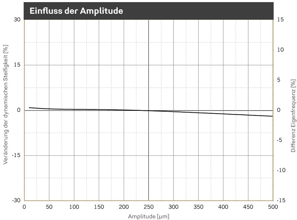
Veränderung der Steifigkeit aufgrund geänderter Anregeamplitude. Mittelwert für 5 Hz, 10 Hz und 40 Hz Anregung. Sinusförmige Anregung bei konstanter Mittellast von 0,220 N/mm<sup>2</sup>, Probenabmessung 300 x 300 x 25 mm. Eigenfrequenz für einen eindimensionalen Feder-Masse-Schwinger auf starrem Untergrund.
