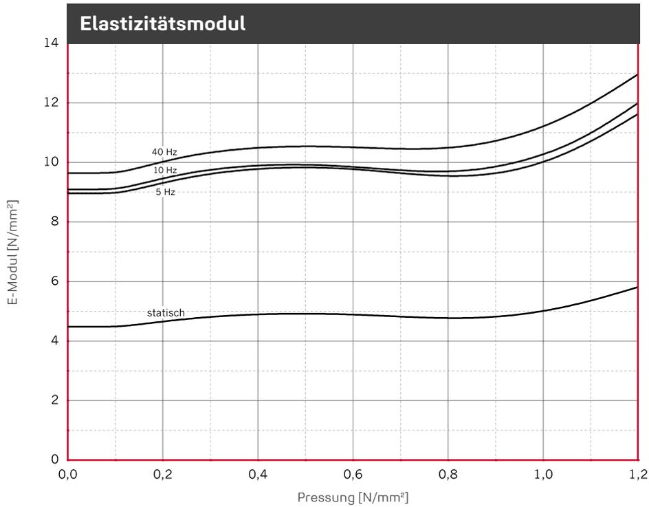
Verlauf des dynamischen E-Moduls bei sinusförmiger Anregung um eine konstante Mittellast, Wegamplitude  $\pm 0,25$  mm. Probenabmessung 250 mm x 250 mm x 25 mm; Statischer E-Modul als Tangentenmodul aus der Federkennlinie. Messung in Anlehnung an DIN 53513.
