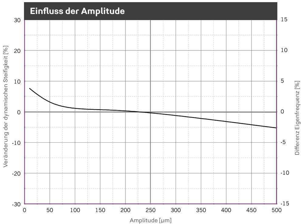
Veränderung der Steifigkeit aufgrund geänderter Anregeamplitude. Mittelwert für 5 Hz, 10 Hz und 40 Hz Anregung. Sinusförmige Anregung bei konstanter Mittellast von 0,028 N/mm<sup>2</sup>; Probenabmessung 300 x 300 x 25 mm. Eigenfrequenz für einen eindimensionalen Feder-Masse-Schwinger auf starrem Untergrund.
