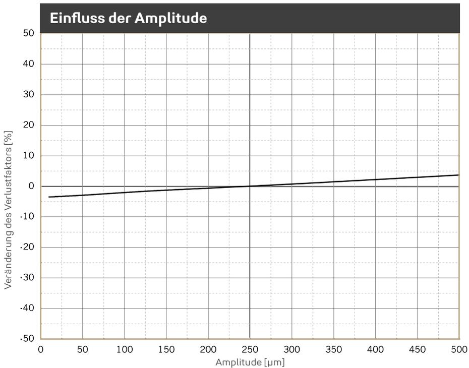
Veränderung des Verlustfaktors aufgrund geänderter Anregeamplitude. Sinusförmige Anregung bei konstanter Mittellast von 0,220 N/mm<sup>2</sup>, Probenabmessung 300 x 300 x 25 mm.
