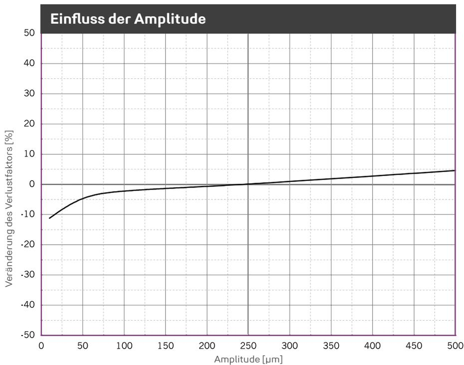
Veränderung des Verlustfaktors aufgrund geänderter Anregeamplitude. Sinusförmige Anregung bei konstanter Mittellast von 0,028 N/mm<sup>2</sup>; Probenabmessung 300 x 300 x 25 mm.
