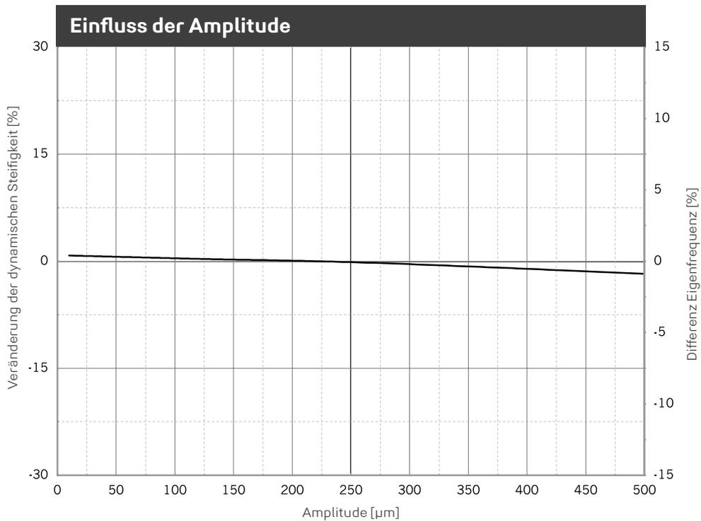
Veränderung der Steifigkeit aufgrund geänderter Amplitude. Mittelwert für 5 Hz, 10 Hz und 40 Hz Anregung. Sinusförmige Anregung bei konstanter Mittellast von 0,110 N/mm<sup>2</sup>, Probenabmessung 300 x 300 x 25 mm. Eigenfrequenz für einen eindimensionalen Feder-Masse-Schwinger auf starrem Untergrund.
