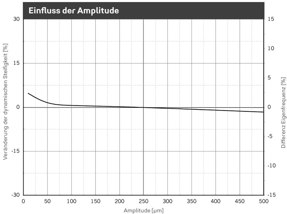
Veränderung der Steifigkeit aufgrund geänderter Anregeamplitude. Mittelwert für 5 Hz, 10 Hz und 40 Hz Anregung. Sinusförmige Anregung bei konstanter Mittellast von 0,055 N/mm<sup>2</sup>; Probenabmessung 300 x 300 x 25 mm. Eigenfrequenz für einen eindimensionalen Feder-Masse-Schwinger auf starrem Untergrund.
