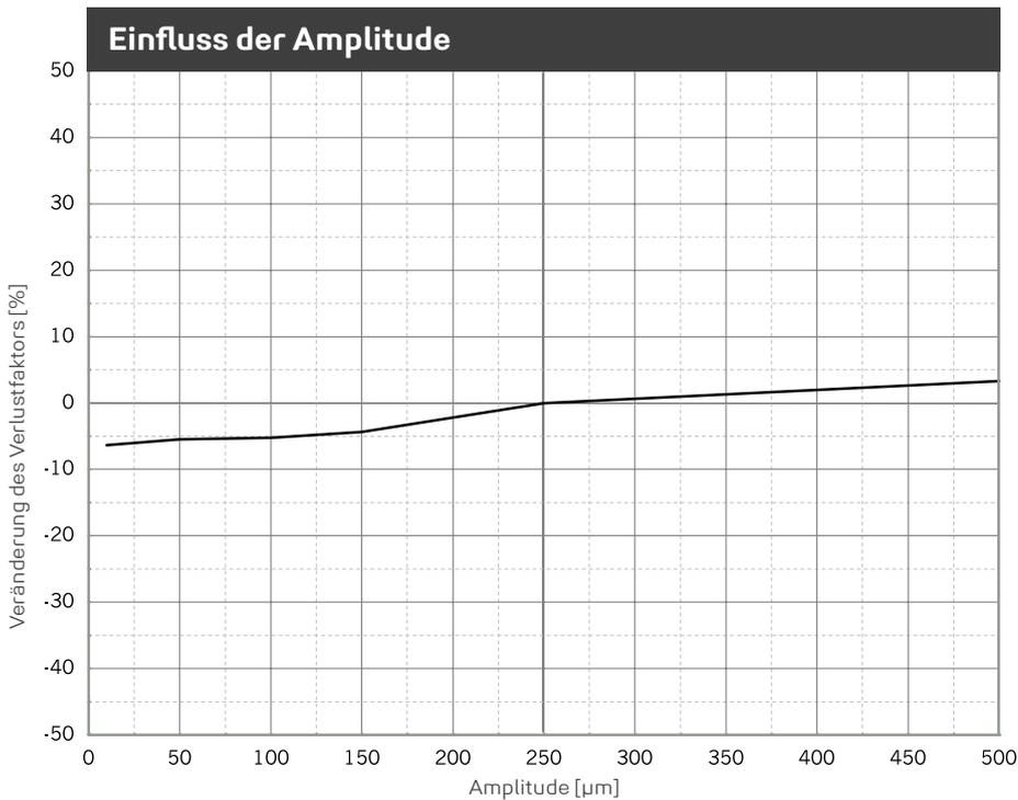
Veränderung des Verlustfaktors aufgrund geänderter Amplitude. Sinusförmige Anregung bei konstanter Mittellast von 0,110 N/mm<sup>2</sup>, Probenabmessung 300 x 300 x 25 mm.
