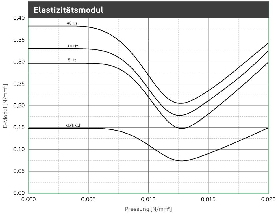
Verlauf des dynamischen E-Moduls bei sinusförmiger Anregung um eine konstante Mittellast, Wegamplitude  $\pm 0,25$  mm. Probenabmessung 300 mm x 300 mm x 25 mm; Statischer E-Modul als Tangentenmodul aus der Federkennlinie. Messung in Anlehnung an DIN 53513.
