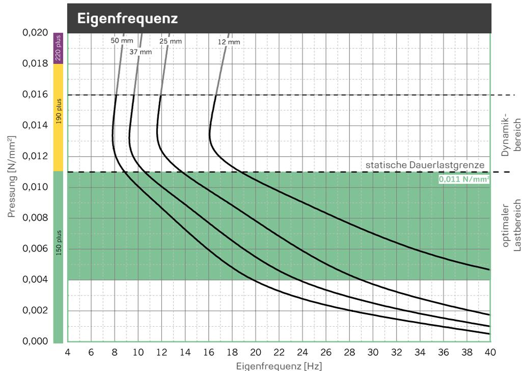
Eigenfrequenzverläufe für einen eindimensionalen Feder-Masse-Schwinger unter Berücksichtigung der dynamischen Steifigkeit von **REGUFOAM vibration 150plus** auf starrem Untergrund. Probenabmessung 300 mm x 300 mm.
