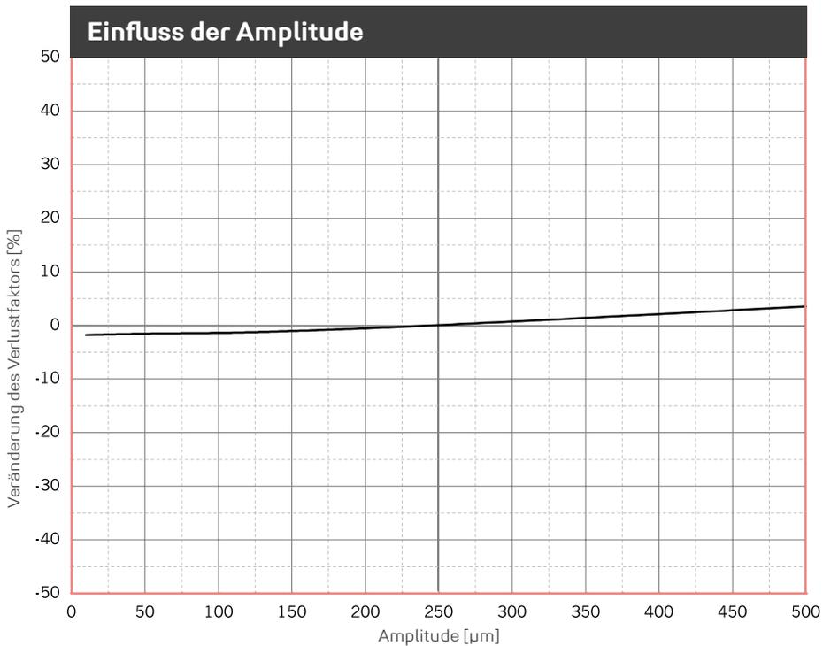
Veränderung des Verlustfaktors aufgrund geänderter Amplitude. Sinusförmige Anregung bei konstanter Mittellast von 0,300 N/mm<sup>2</sup>. Probenabmessung 300 x 300 x 25 mm.
