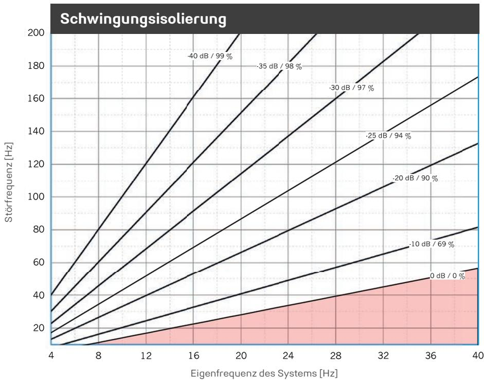
Dargestellt ist die Isolierwirkung für einen Ein-Massen-Schwinger auf starrem Untergrund mit **REGUFOAM vibration 270plus**. Parameter: Kraftübertragungsmaß in dB, Isolierungsgrad in %.
