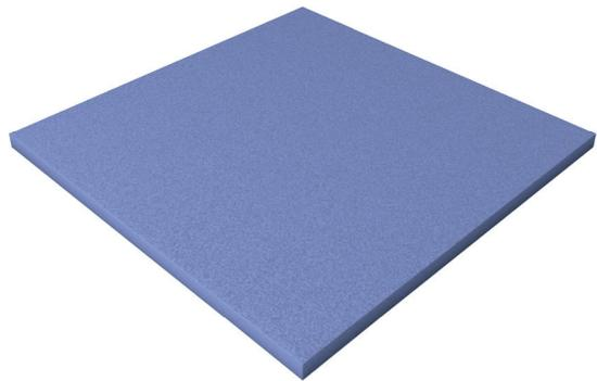
**REGUFOAM vibration** ist weitestgehend feuchtigkeitsbeständig und verrottungsfest. Die Ozonbeständigkeit ist gegeben, jedoch können die Farben im Laufe der Zeit durch die UV-Strahlung verblassen. Aufgrund der gemischtzelligen Struktur können insbesondere Typen mit geringerer dynamischer Steifigkeit Wasser aufnehmen. Diese sind vor Wassereintrag zu schützen.
