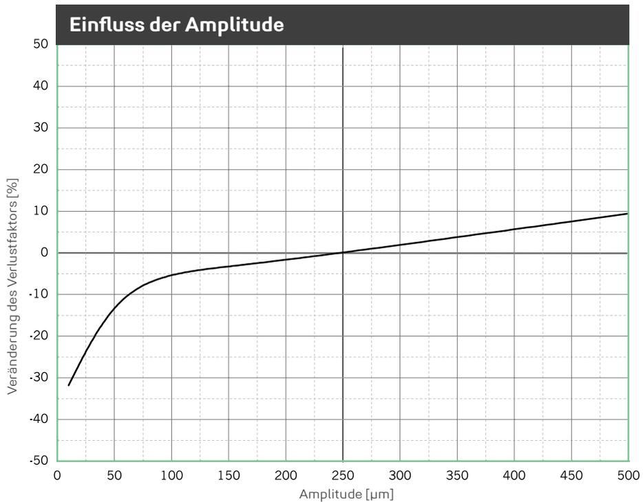
Veränderung des Verlustfaktors aufgrund geänderter Amplitude. Sinusförmige Anregung bei konstanter Mittellast von 0,011 N/mm<sup>2</sup>; Probenabmessung 300 x 300 x 25 mm.
