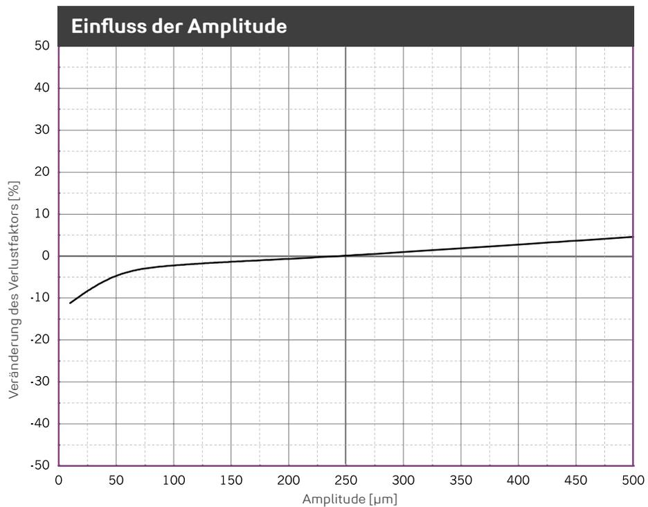
Veränderung des Verlustfaktors aufgrund geänderter Amplitude. Sinusförmige Anregung bei konstanter Mittellast von 0,028 N/mm<sup>2</sup>, Probenabmessung 300 x 300 x 25 mm.
