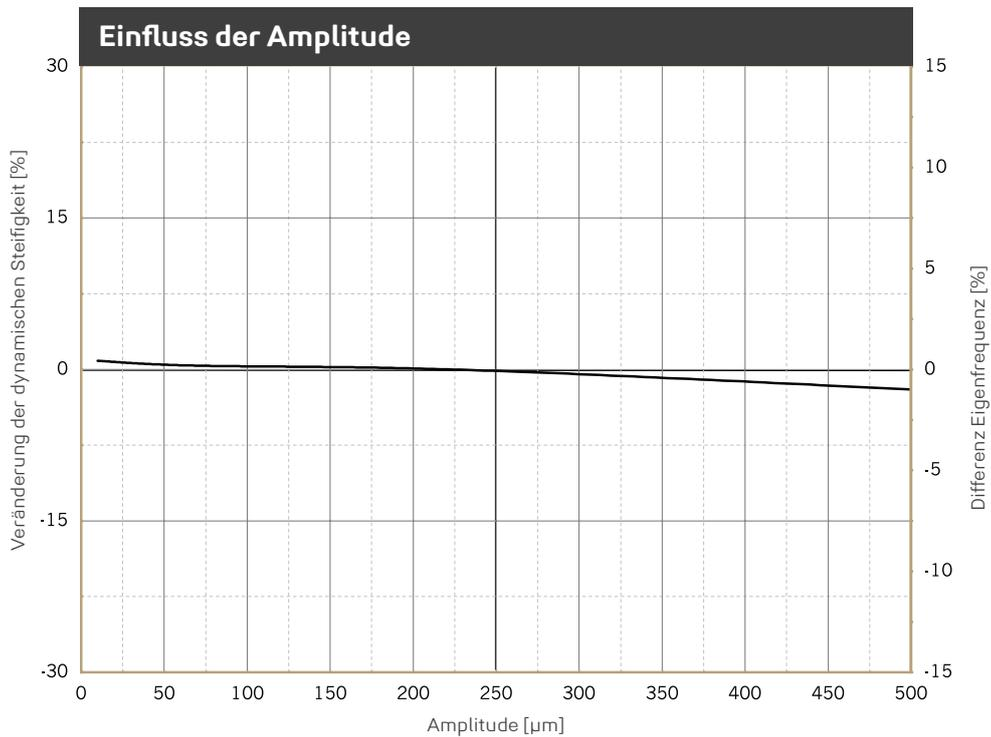
Veränderung der Steifigkeit aufgrund geänderter Amplitude. Mittelwert für 5 Hz, 10 Hz und 40 Hz Anregung. Sinusförmige Anregung bei konstanter Mittellast von 0,220 N/mm<sup>2</sup>, Probenabmessung 300 x 300 x 25 mm. Eigenfrequenz für einen eindimensionalen Feder-Masse-Schwinger auf starrem Untergrund.
