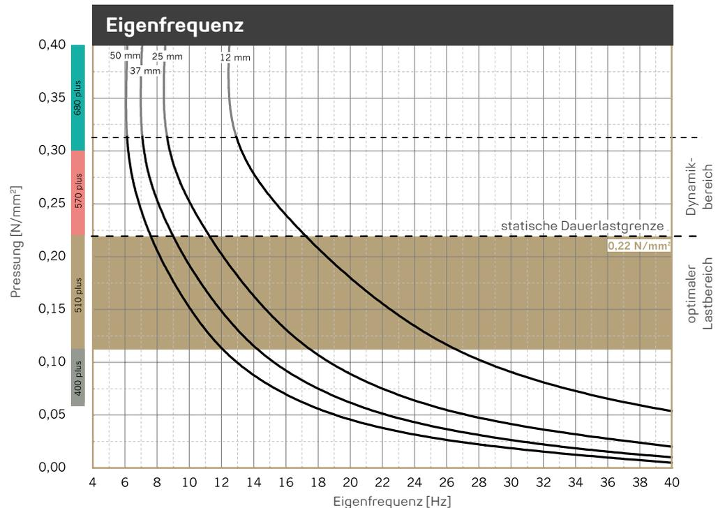
Eigenfrequenzverläufe für einen eindimensionalen Feder-Masse-Schwinger unter Berücksichtigung der dynamischen Steifigkeit von **REGUFOAM vibration 510plus** auf starrem Untergrund. Probenabmessung 300 mm x 300 mm.
