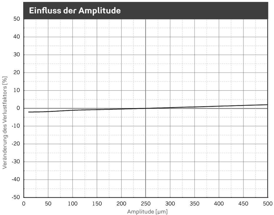
Veränderung des Verlustfaktors aufgrund geänderter Anregeamplitude. Sinusförmige Anregung bei konstanter Mittellast von 0,055 N/mm<sup>2</sup>, Probenabmessung 300 x 300 x 25 mm.
