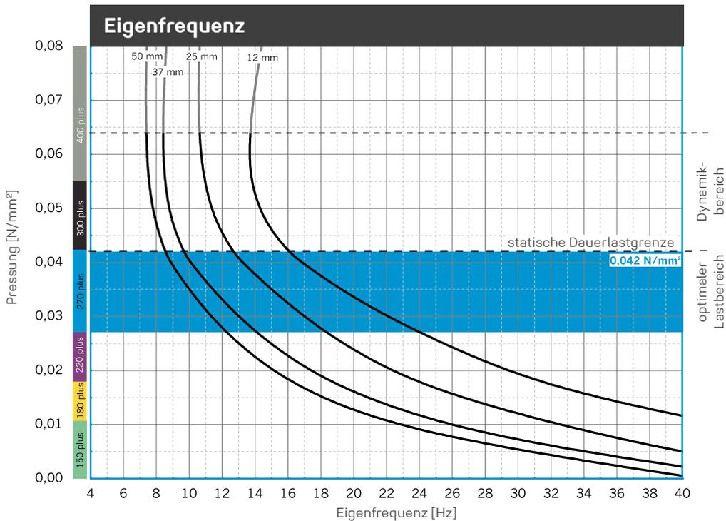
Eigenfrequenzverläufe für einen eindimensionalen Feder-Masse-Schwinger unter Berücksichtigung der dynamischen Steifigkeit von **REGUFOAM vibration 270plus** auf starrem Untergrund. Probenabmessung 300 mm x 300 mm.
