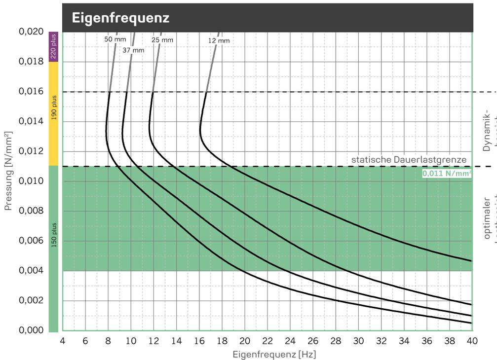
Eigenfrequenzverläufe für einen eindimensionalen Feder-Masse-Schwinger unter Berücksichtigung der dynamischen Steifigkeit von **REGUFOAM vibration 150plus** auf starrem Untergrund. Probenabmessung 300 mm x 300 mm.
