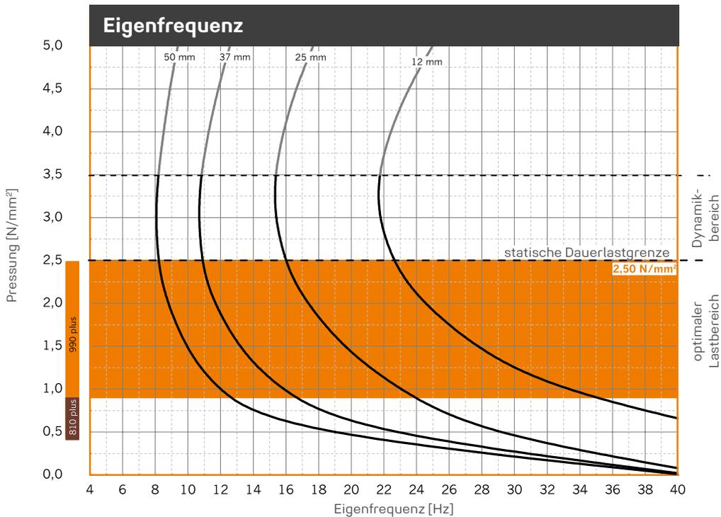
Eigenfrequenzverläufe für einen eindimensionalen Feder-Masse-Schwinger unter Berücksichtigung der dynamischen Steifigkeit von **REGUFOAM vibration 990plus** auf starrem Untergrund. Probenabmessung 125 mm x 125 mm.
