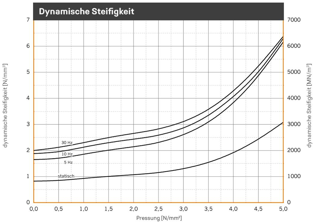
Verlauf der dynamischen Steifigkeit bei sinusförmiger Anregung um eine konstante Mittellast, Wegamplitude  $\pm 0,10$  mm. Probenabmessung 125 mm x 125 mm x 25 mm; Statische Steifigkeit als Tangentenmodul aus der Federkennlinie. Messung in Anlehnung an DIN 53513.
