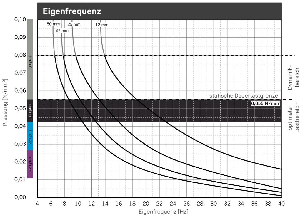
Eigenfrequenzverläufe für einen eindimensionalen Feder-Masse-Schwinger unter Berücksichtigung der dynamischen Steifigkeit von **REGUFOAM vibration 300plus** auf starrem Untergrund. Probenabmessung 300 mm x 300 mm.
