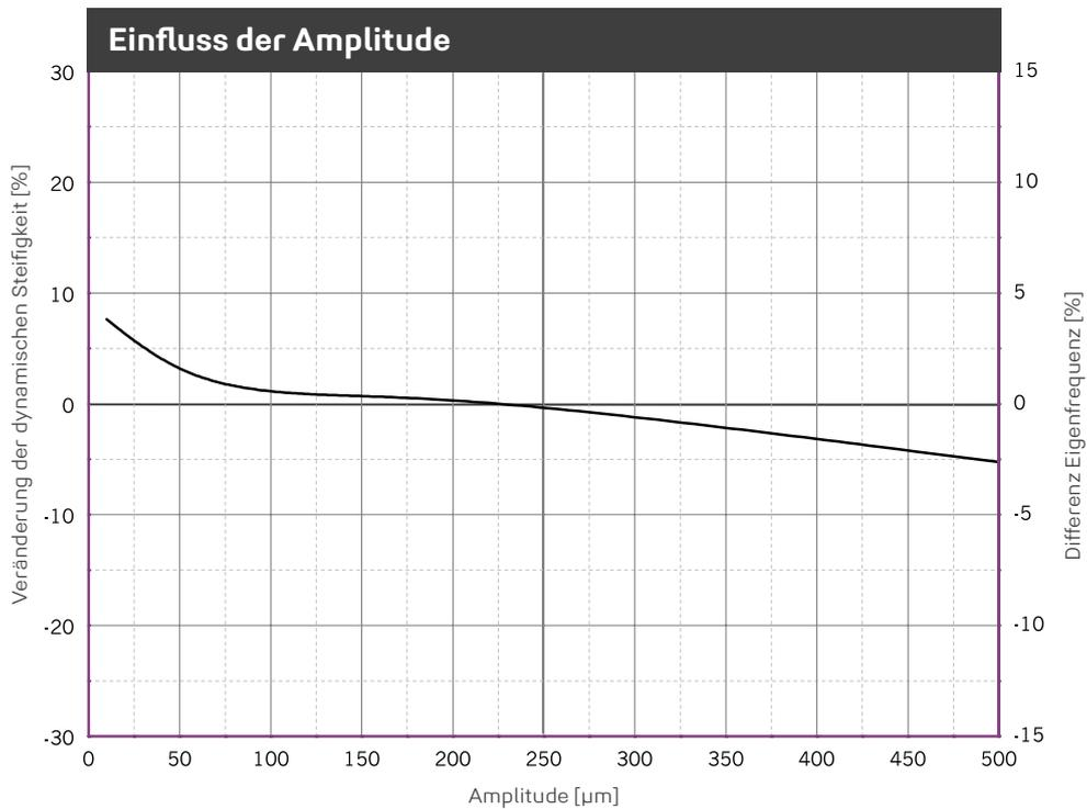
Veränderung der Steifigkeit aufgrund geänderter Amplitude. Mittelwert für 5 Hz, 10 Hz und 40 Hz Anregung. Sinusförmige Anregung bei konstanter Mittellast von 0,028 N/mm<sup>2</sup>, Probenabmessung 300 x 300 x 25 mm. Eigenfrequenz für einen eindimensionalen Feder-Masse-Schwinger auf starrem Untergrund.
