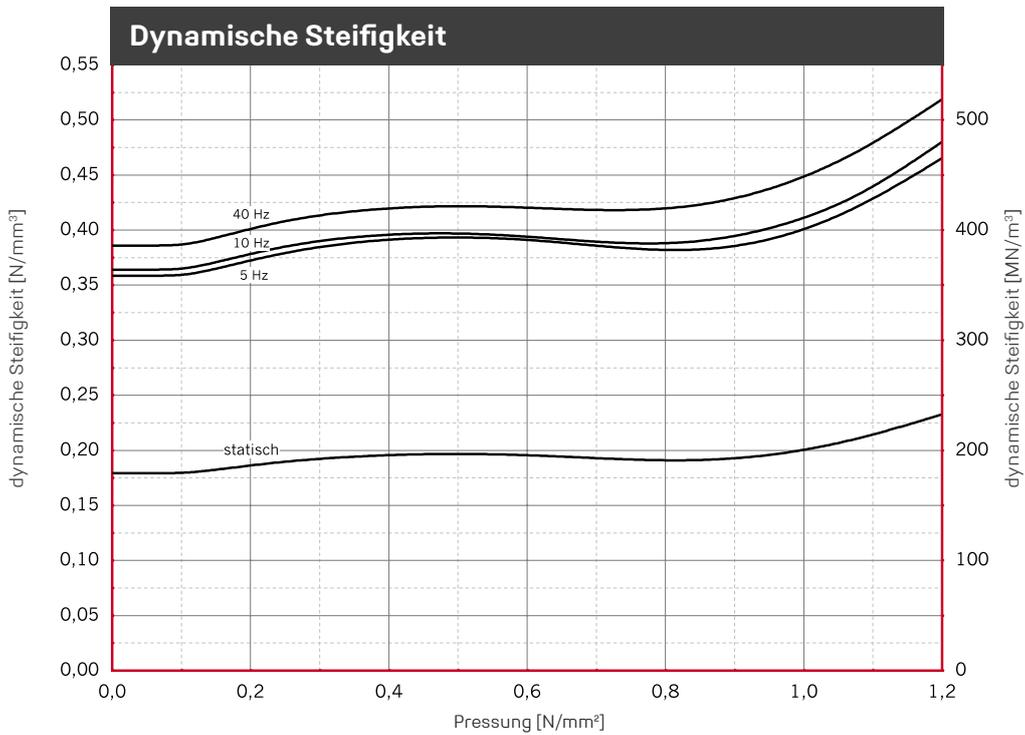
Verlauf der dynamischen Steifigkeit bei sinusförmiger Anregung um eine konstante Mittellast, Wegamplitude  $\pm 0,25$  mm. Probenabmessung 250 mm x 250 mm x 25 mm; Statische Steifigkeit als Tangentenmodul aus der Federkennlinie. Messung in Anlehnung an DIN 53513.
