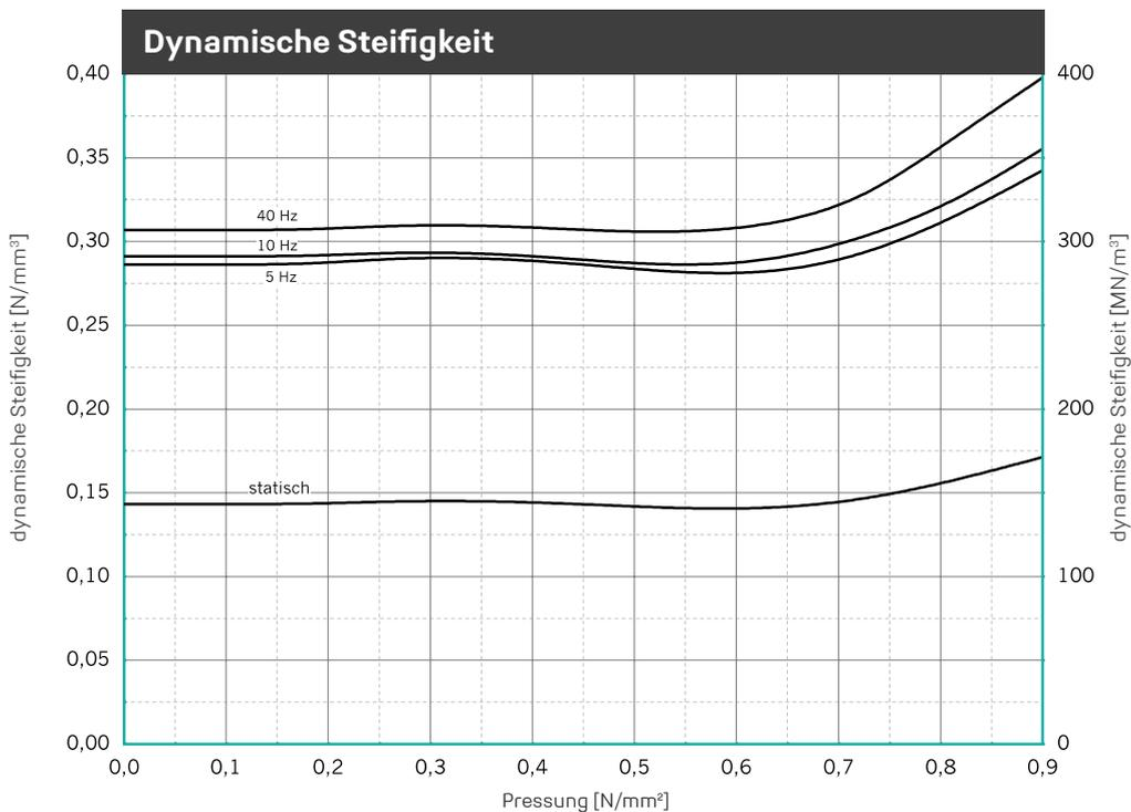
Verlauf der dynamischen Steifigkeit bei sinusförmiger Anregung um eine konstante Mittellast, Wegamplitude  $\pm 0,25$  mm. Probenabmessung 300 mm x 300 mm x 25 mm; Statische Steifigkeit als Tangentenmodul aus der Federkennlinie. Messung in Anlehnung an DIN 53513.
