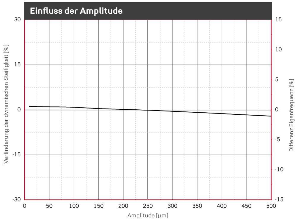
Veränderung der Steifigkeit aufgrund geänderter Amplitude. Mittelwert für 5 Hz, 10 Hz und 40 Hz Anregung. Sinusförmige Anregung bei konstanter Mittellast von 0,600 N/mm<sup>2</sup>, Probenabmessung 250 x 250 x 50 mm. Eigenfrequenz für einen eindimensionalen Feder-Masse-Schwinger auf starrem Untergrund.
