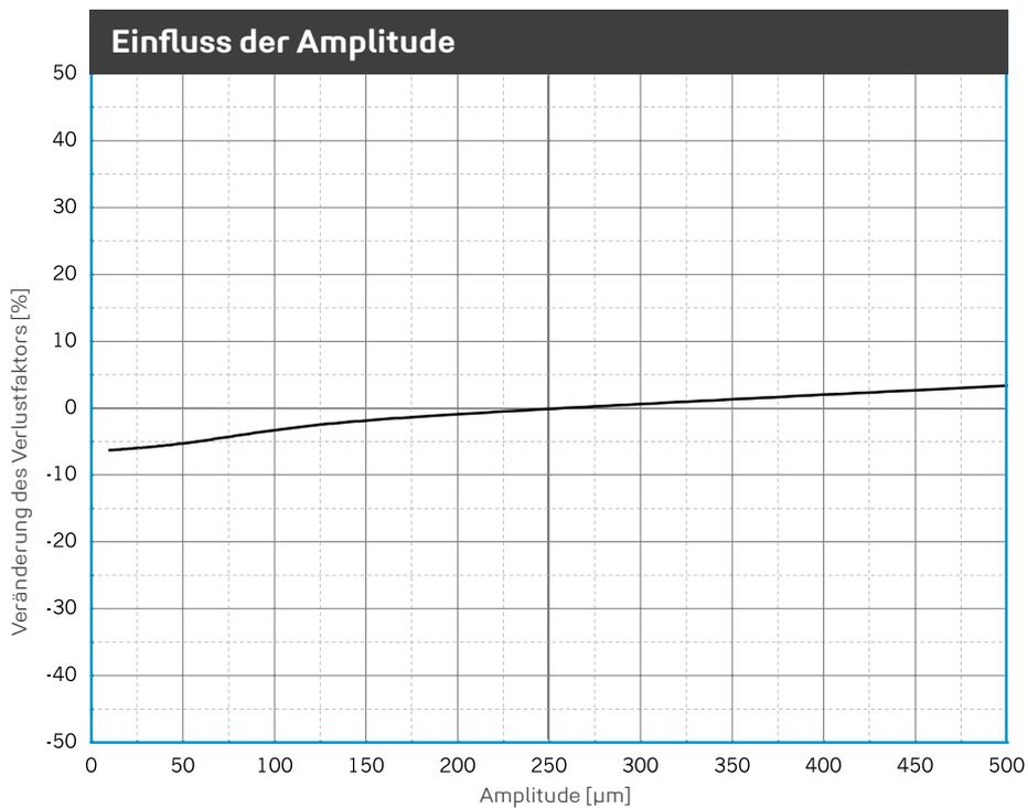
Veränderung des Verlustfaktors aufgrund geänderter Amplitude. Sinusförmige Anregung bei konstanter Mittellast von 0,042 N/mm<sup>2</sup>, Probenabmessung 300 x 300 x 25 mm.
