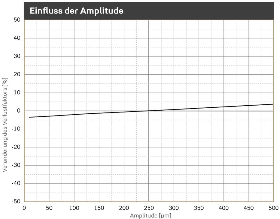
Veränderung des Verlustfaktors aufgrund geänderter Amplitude. Sinusförmige Anregung bei konstanter Mittellast von 0,220 N/mm<sup>2</sup>, Probenabmessung 300 x 300 x 25 mm.
