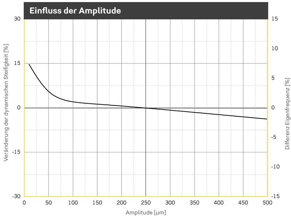
Veränderung der Steifigkeit aufgrund geänderter Amplitude. Mittelwert für 5 Hz, 10 Hz und 40 Hz Anregung. Sinusförmige Anregung bei konstanter Mittellast von 0,018 N/mm<sup>2</sup>, Probenabmessung 300 x 300 x 25 mm. Eigenfrequenz für einen eindimensionalen Feder-Masse-Schwinger auf starrem Untergrund.
