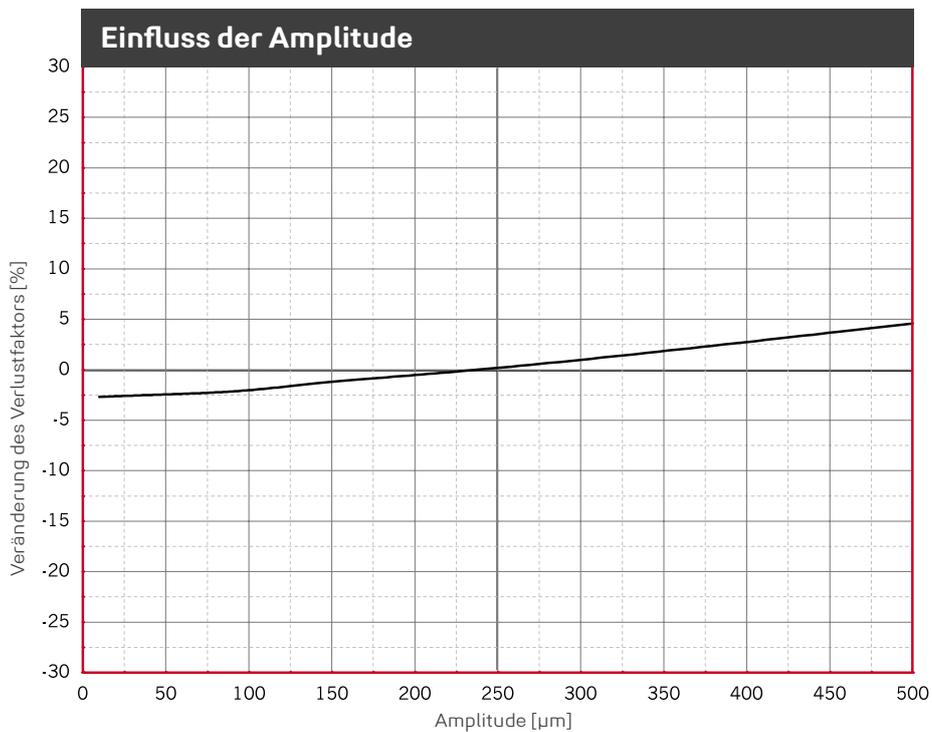
Veränderung des Verlustfaktors aufgrund geänderter Amplitude. Sinusförmige Anregung bei konstanter Mittellast von 0,600 N/mm<sup>2</sup>, Probenabmessung 250 x 250 x 50 mm.
