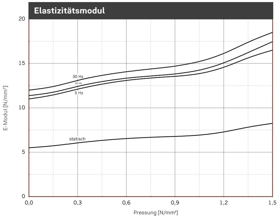
Verlauf des dynamischen E-Moduls bei sinusförmiger Anregung um eine konstante Mittellast, Wegamplitude  $\pm 0,10$  mm. Probenabmessung 250 mm x 250 mm x 25 mm; Statischer E-Modul als Tangentenmodul aus der Federkennlinie. Messung in Anlehnung an DIN 53513.
