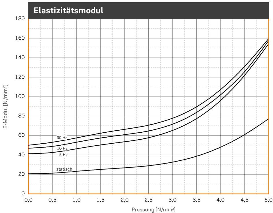
Verlauf des dynamischen E-Moduls bei sinusförmiger Anregung um eine konstante Mittellast, Wegamplitude  $\pm 0,10$  mm. Probenabmessung 125 mm x 125 mm x 25 mm; Statischer E-Modul als Tangentenmodul aus der Federkennlinie. Messung in Anlehnung an DIN 53513.
