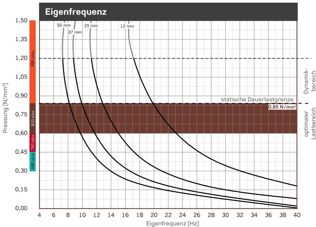
Eigenfrequenzverläufe für einen eindimensionalen Feder-Masse-Schwinger unter Berücksichtigung der dynamischen Steifigkeit von **REGUFOAM vibration 810plus** auf starrem Untergrund. Probenabmessung 250 mm x 250 mm.
