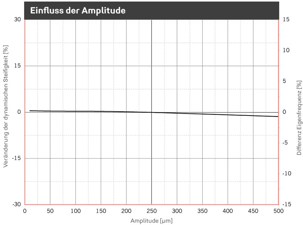
Veränderung der Steifigkeit aufgrund geänderter Amplitude. Mittelwert für 5 Hz, 10 Hz und 40 Hz Anregung. Sinusförmige Anregung bei konstanter Mittellast von 0,300 N/mm<sup>2</sup>, Probenabmessung 300 x 300 x 25 mm. Eigenfrequenz für einen eindimensionalen Feder-Masse-Schwinger auf starrem Untergrund.
