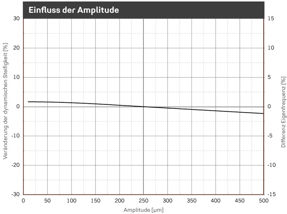
Veränderung der Steifigkeit aufgrund geänderter Amplitude. Mittelwert für 5 Hz, 10 Hz und 40 Hz Anregung. Sinusförmige Anregung bei konstanter Mittellast von 0,850 N/mm<sup>2</sup>, Probenabmessung 250 x 250 x 25 mm. Eigenfrequenz für einen eindimensionalen Feder-Masse-Schwinger auf starrem Untergrund.
