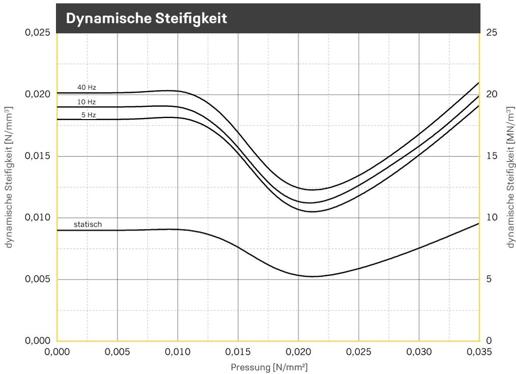
Verlauf der dynamischen Steifigkeit bei sinusförmiger Anregung um eine konstante Mittellast, Wegamplitude  $\pm 0,25$  mm. Probenabmessung 300 mm x 300 mm x 25 mm; Statische Steifigkeit als Tangentenmodul aus der Federkennlinie. Messung in Anlehnung an DIN 53513.
