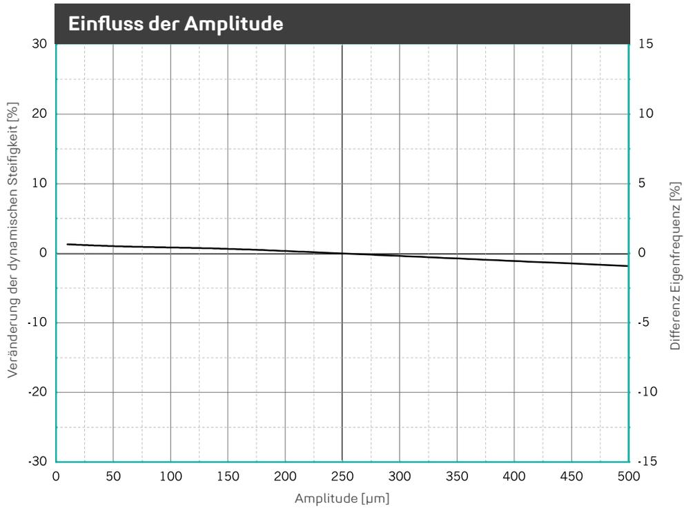
Veränderung der Steifigkeit aufgrund geänderter Amplitude. Mittelwert für 5 Hz, 10 Hz und 40 Hz Anregung. Sinusförmige Anregung bei konstanter Mittellast von 0,450 N/mm<sup>2</sup>, Probenabmessung 300 x 300 x 25 mm. Eigenfrequenz für einen eindimensionalen Feder-Masse-Schwinger auf starrem Untergrund.
