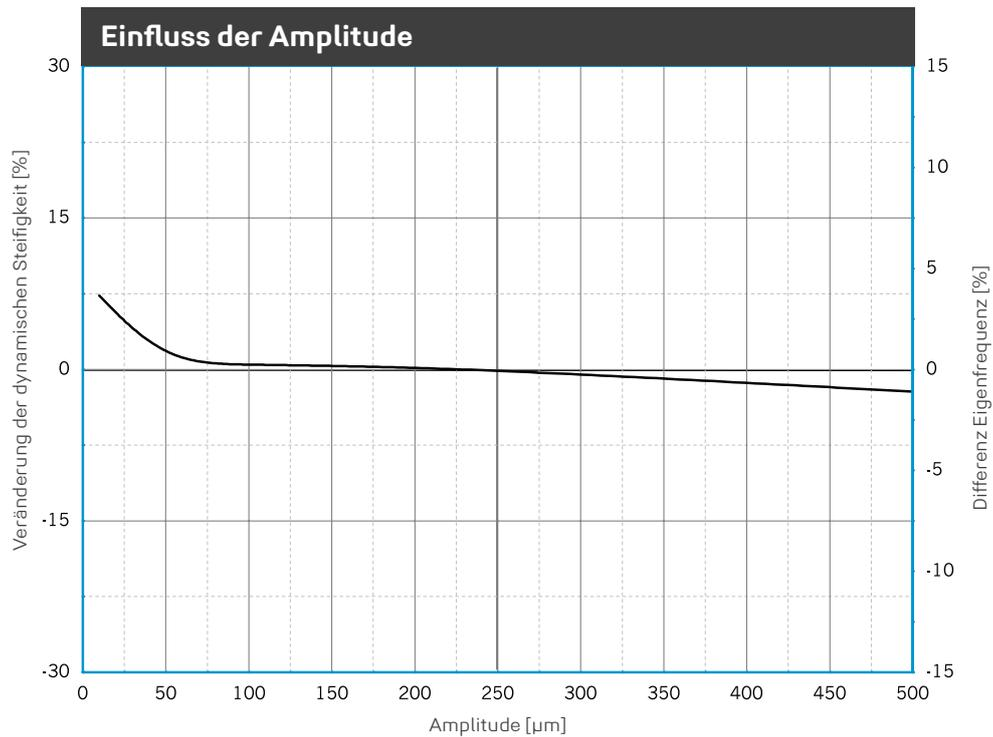
Veränderung der Steifigkeit aufgrund geänderter Amplitude. Mittelwert für 5 Hz, 10 Hz und 40 Hz Anregung. Sinusförmige Anregung bei konstanter Mittellast von 0,042 N/mm<sup>2</sup>, Probenabmessung 300 x 300 x 25 mm. Eigenfrequenz für einen eindimensionalen Feder-Masse-Schwinger auf starrem Untergrund.
