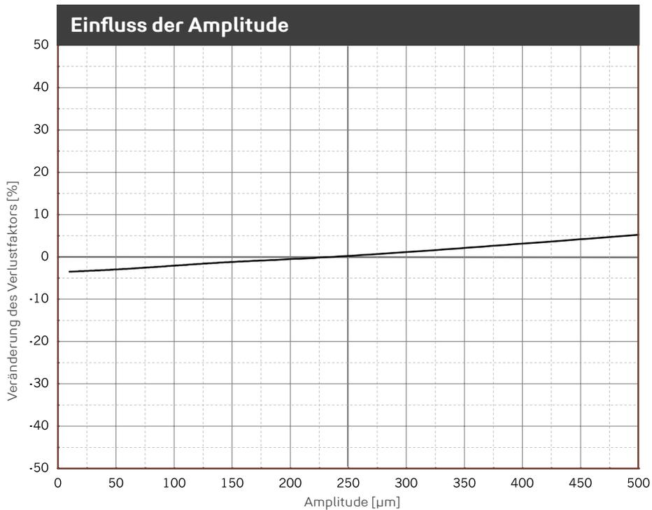
Veränderung des Verlustfaktors aufgrund geänderter Amplitude. Sinusförmige Anregung bei konstanter Mittellast von 0,850 N/mm<sup>2</sup>, Probenabmessung 250 x 250 x 25 mm.
