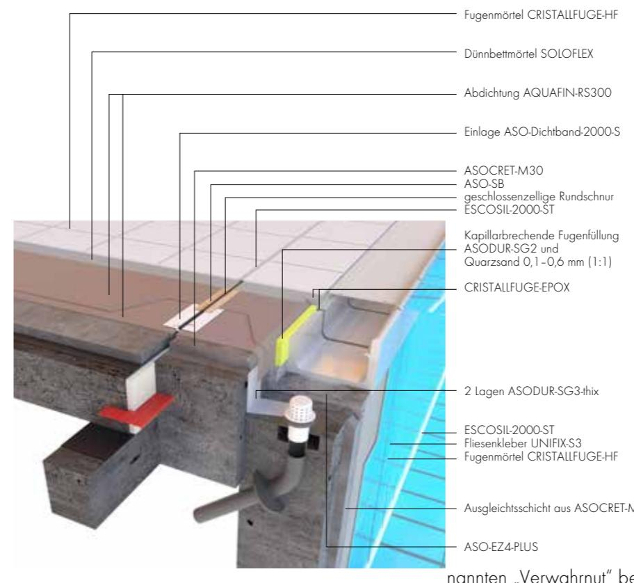
Um einen schädigenden Einfluss dieses hinter die Abdichtungsebene gelangten Wassers auf den Haftverbund der Abdichtung zu verhindern, empfehlen wir folgende mögliche Ausführungsvarianten (siehe Zeichnungen):
