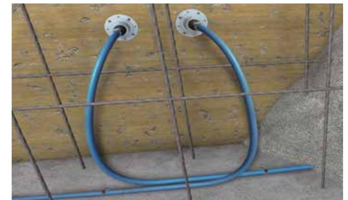
Durch die einfache Befestigungsart lassen sich auch schwierige Fugenverläufe anpassen. Bei Kontakt mit Wasser reagiert das enthaltene thermoplastische Elastomer und führt zu einer Volumenvergrößerung. Durch den resultierenden Anpressdruck dichtet das Material anschließend die Arbeitsfuge gegen die umliegenden Betonflanken ab.
