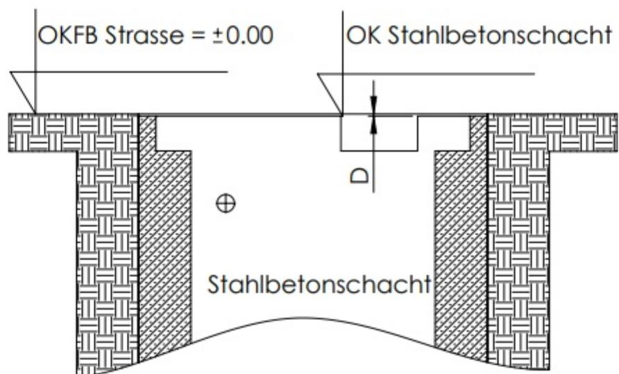
D = -6 mm bei Standard Stahlplattenabdeckung
