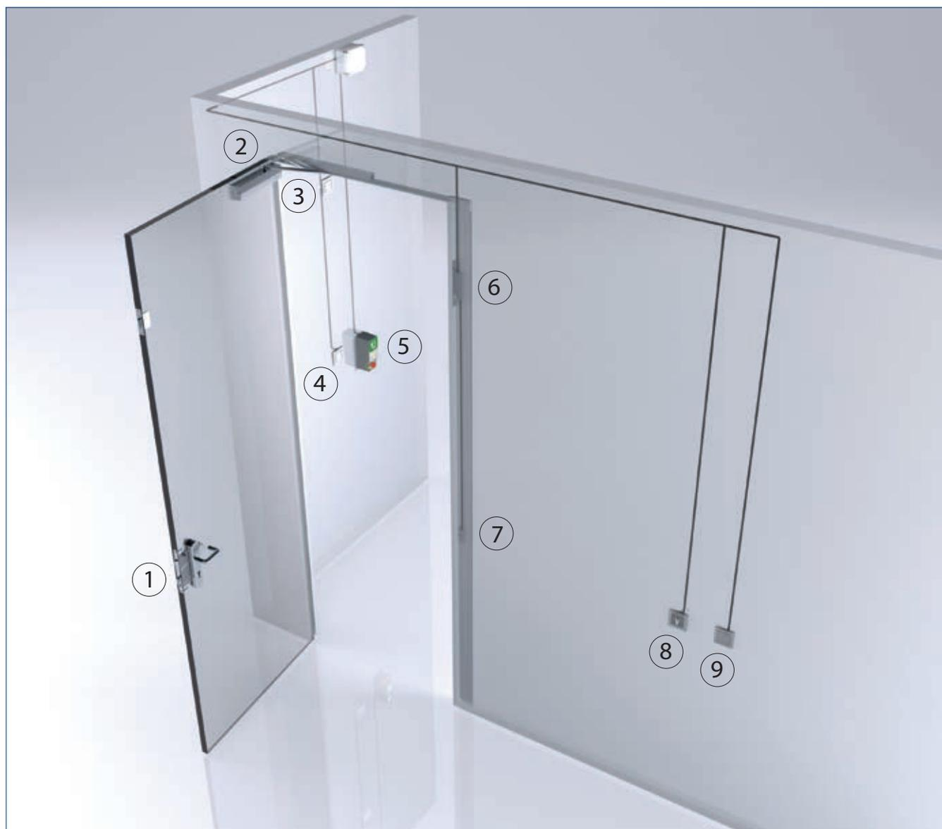
1 = Panikschloss mit Wechselfunktion „E“ bauseits | 2 = Türschließer TS 4000/TS 5000 | 3 = Taster auf 1,80 m Höhe | 4 = Schalter zum Aktivieren bzw. Deaktivieren des äußeren Tasters | 5 = Türzentrale TZ 320 SN, AP/UP | 6 = Fluchttürverriegelung FTV 320 | 7 = Elektrischer Türöffner A5000--B | 8 = Schlüsseltaster | 9 = Taster außen
