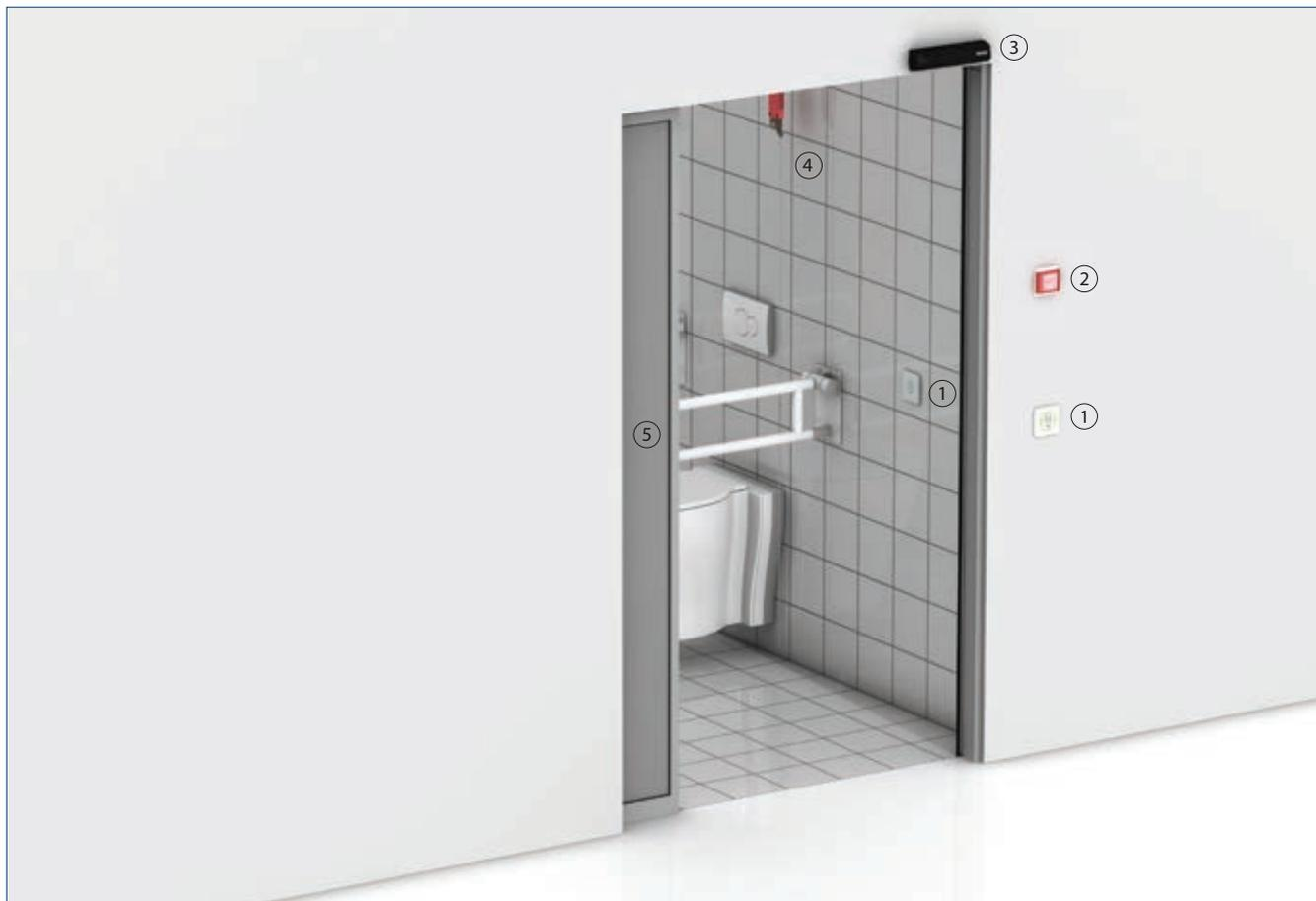
1 = Berührungsloser Näherungstaster (innen und außen) | 2 = Not-Aus Schalter (Empfehlung Installationshöhe: 1600 mm) | 3 = Aktiv-Infrarot-Lichtvorhang | 4 = Zugschalter Notruf | 5 = Schiebetürflügel
