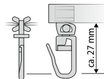
**A6 Teflongleiter mit drehbarem Faltenhaken**
