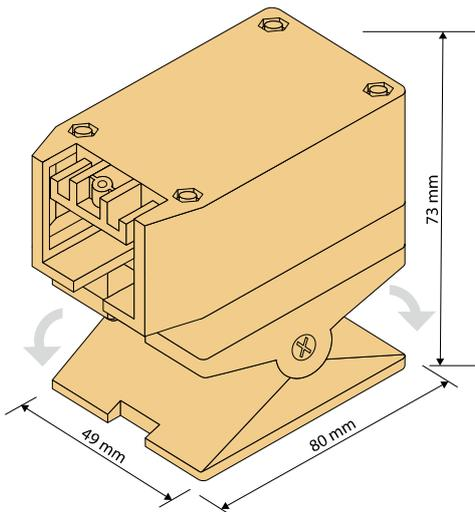
Der Slope-Winkeladapter ermöglicht einen optimierten Einbau bei schrägen Motoranlagen, so dass sich der Motor an die Schräge anpasst und es somit zu keiner störenden Montage durch den Motor-Antrieb kommen kann.
