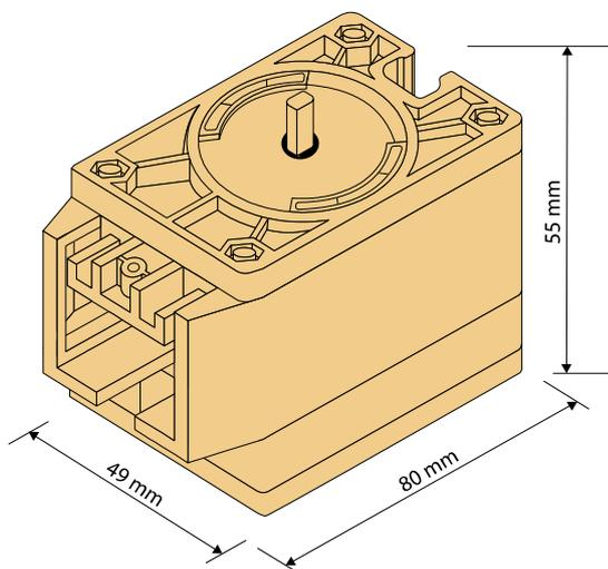
In speziellen Einbausituationen ist es erforderlich, dass der Antrieb einer Motorschiene nicht sichtbar sein soll. Dieser Adapter ermöglicht einen versteckten Einbau des Motors in einer abgehangenen Decke. Somit kann die Parkposition des Stoffbehanges unabhängig von der Motorseite gewählt werden.
