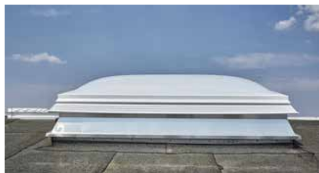
Aufstocksystem ASM, 15 cm Höhe (optional 30 cm Höhe) Aufstocker und Montagerahmen mit Wetterschutzkante
