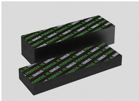
FOAMGLAS® PERINSUL HL ist ein Spezialprodukt mit extrem hoher Druckfestigkeit zur Vermeidung von Wärmebrücken. Die Dämmelemente sind ober- und unterseitig mit Bitumen und Spezialglasvlies kaschiert, um die Baustoffverträglichkeit mit Mörtel und anderen Baumaterialien sicher zu stellen. Die oberseitige Kaschierung ist grün.
