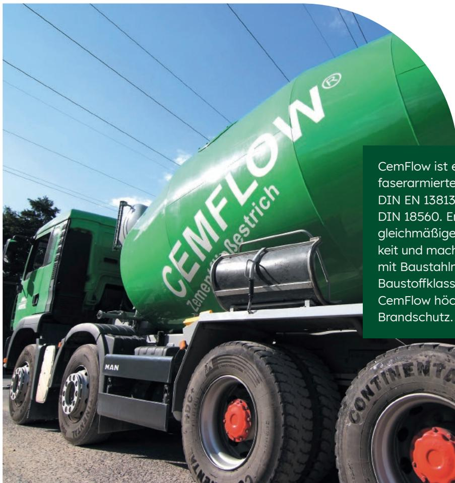
CemFlow ist ein zementgebundener, faserarmer Fließestrich CT nach DIN EN 13813 – geeignet als CT nach DIN 18560. Er verfügt über eine hohe, gleichmäßige Druck- und Biegezugfestigkeit und macht eine zusätzliche Bewehrung mit Baustahlmatten überflüssig. Mit der Baustoffklasse A1 (nicht brennbar) erfüllt CemFlow höchste Anforderungen an den Brandschutz.
