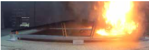
Minute 7 ohne MB PUReactive+ (nach 11 Minuten Vollbrand)
