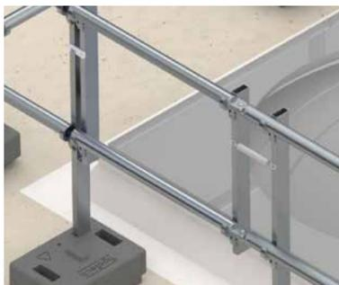
Das GUARD TÜR System ermöglicht dem Benutzer die gesicherte Dachfläche zu betreten bzw. diese zu verlassen. Das GUARD TÜR-System ist so konzipiert, dass es nach dem Öffnen selbstständig zufällt. Es ist in zwei Ausbaustufen erhältlich: für geneigte GUARD Systeme nach außen zu öffnen und für nicht geneigte Systeme nach innen zu öffnen.
