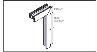
7 Die ersten Klemmnippel von oben und unten ca. 100 mm von Außenkante Blendrahmen und alle Weiteren mit einem Abstand von max. 300 mm anschrauben.
