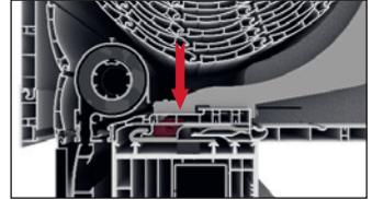
**1** Die Statikkonsole wird mit dem Kasten zusammen aufgerastet. Setzen Sie den Kasten schräg auf.
