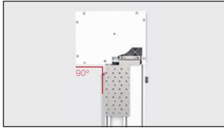
6 90° Winkel des Kastens innen prüfen! Verbinden Sie Aufsatzkasten und Blendrahmen mit den Befestigungsstielen und positionieren Sie die Klemmnippel auf dem Blendrahmen.
