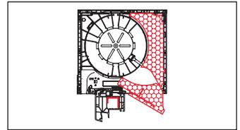
2 Entfernen Sie den zweigeteilten Dämmkeil aus dem Rollladenkasten.
