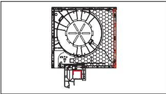
1 Fahren Sie den Behang nach unten und lösen Sie die PVC Revisionsblende aus der unteren Blende.
