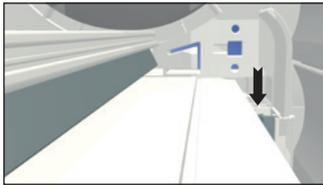
3 Fädeln Sie den Insektenschutz von oben in die Insektenschutzführung ein und rasten Sie den Insektenschutz an beiden Seiten in die Kopfstücke ein.
