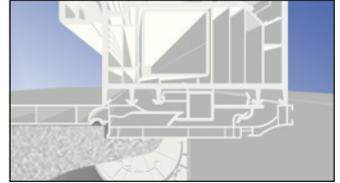
**2** Verbinden Sie den Blendrahmen mittels Verbindungsprofil mit dem Kasten. Beginnen Sie mit dem Einrasten des Verbindungsprofils mit dem Rolladenkasten an einer Seite und arbeiten Sie sich über die Mitte zur anderen Seite vor (nicht gleichzeitig rechts und links einrasten).
