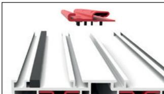
**2** Vor der Montage des Statikprofils ein vorkomprimiertes Dichtband auf den Rahmen aufkleben. Es dürfen ausschließlich 10 mm breite Dichtbänder für eine Fugenbreite von 2-4 mm verwendet werden. Bei Überdimensionierten Bändern kann dies zu einem Spalt zwischen Fenster und Rolladenkasten führen.
