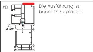
9 Sollte im Bereich der Rollladenführungsschienen und der Kastenblenden ein vorkomprimiertes Dichtband eingesetzt werden, so ist dieses in der Stärke so auszuwählen und so anzubringen, dass die Rollladenführungsschienen, die Kastenblenden und ggf. der Kastenkorpus nicht verformt werden.
