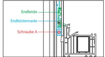
2 Die Endleistenraste in die Insektenschutzführung einschieben, diese Führung in die Aussparung der Rolladenführungsschiene einlassen und verschrauben.
