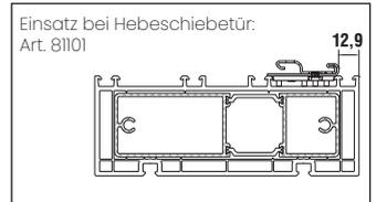
**5** Bei freier Montage des Statikprofils ohne Raststücke ist darauf zu achten, dass das Statikprofil durchgängig im Abstand von 9,6 mm (Art. 81100) bzw. 12,9 mm (Art. 81101) von der Außenkante Blendrahmen befestigt wird.
