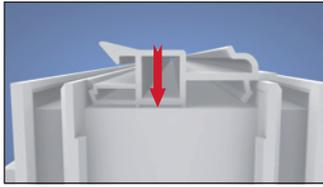
**1** Das Verbindungsprofil wird in der Länge zentriert auf dem Blendrahmen positioniert und aufgeklipst. Das Verbindungsprofil ist 40 mm kürzer als die Blendrahmenbreite! In dem Bereich zwischen Kopfstück und Blendrahmen, wo das Verbindungsprofil zurückspringt, muss nach Aufsetzen des Kastens mit einem geeigneten Dichtstoff abgedichtet werden (siehe Pfeil). Bei Bedarf kann das Verbindungsprofil mit dem Blendrahmen verschraubt werden.
