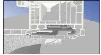
4 Verbinden Sie den Blendrahmen mittels Statikprofil mit dem Kasten. Das Einrasten erfolgt wie bei Punkt 2 auf Seite 4 beschrieben.
