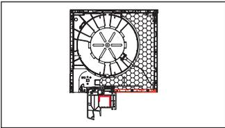
1 Fahren Sie den Behang nach unten und lösen Sie die PVC Revisionsblende aus der Innenblende.
