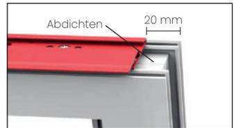
**3** Das Statikprofil mit den Raststücken auf den Blendrahmen aufsetzen. Das Statikprofil ist 40 mm kürzer als die Blendrahmenbreite. In dem Bereich zwischen Kopfstück und Blendrahmen, wo das Verbindungsprofil zurückspringt, muss mit einem geeigneten Dichtstoff abgedichtet werden.
